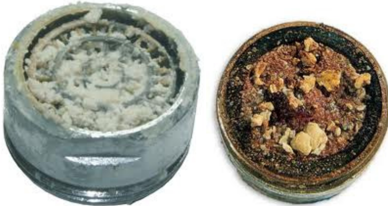
Obr. 1.3. Perlátor zničený vodním kamenem a inkrustací
