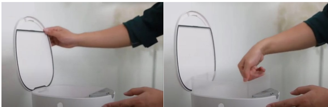
Obr. 2-14 Ukázka vyjímání zásobníku [18]
