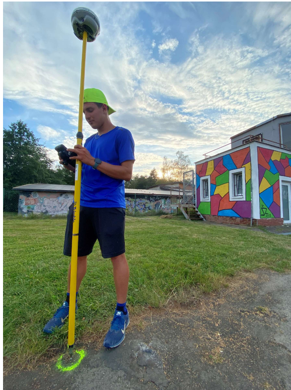
Obrázek 7: Aparatura GNSS-RTK Trimble R6 při měření metodou RTK [autor: Matej Kalamen]
