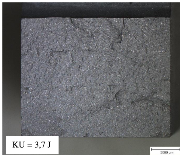
Obr. 7. 11: Lomová plocha vzorku skupiny 3 při zkušební teplotě 90 °C
