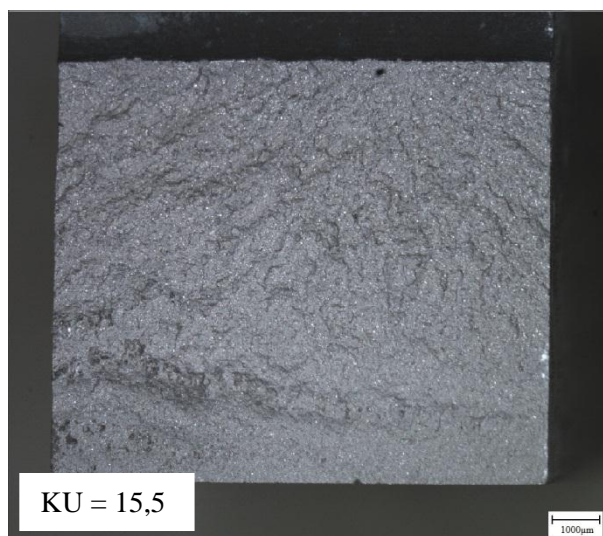
Obr. 7. 8: Lomová plocha vzorku skupiny 2 při zkušební teplotě 20 °C
