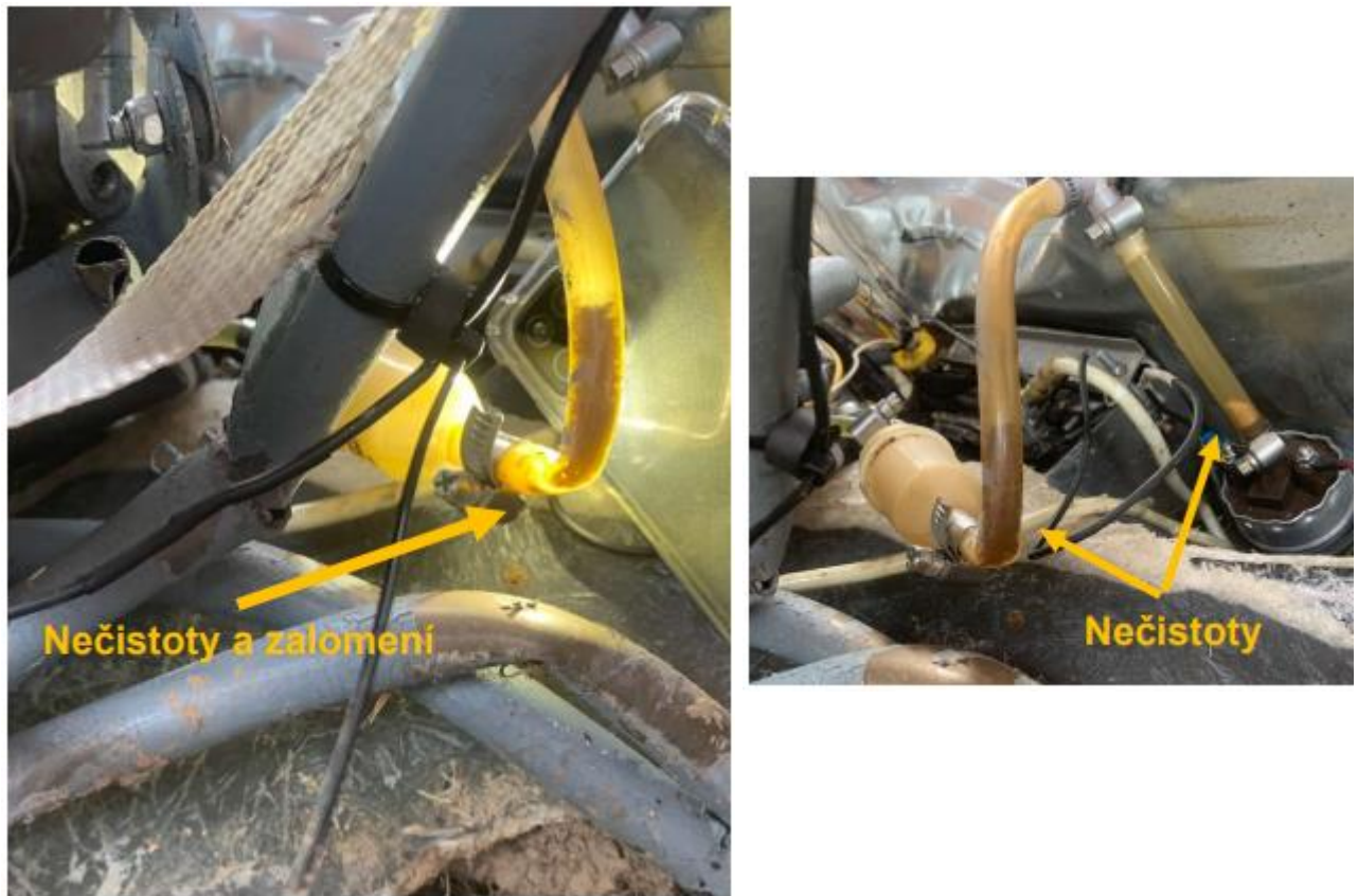
Obr. 21: Nečistoty v motoru [22]
