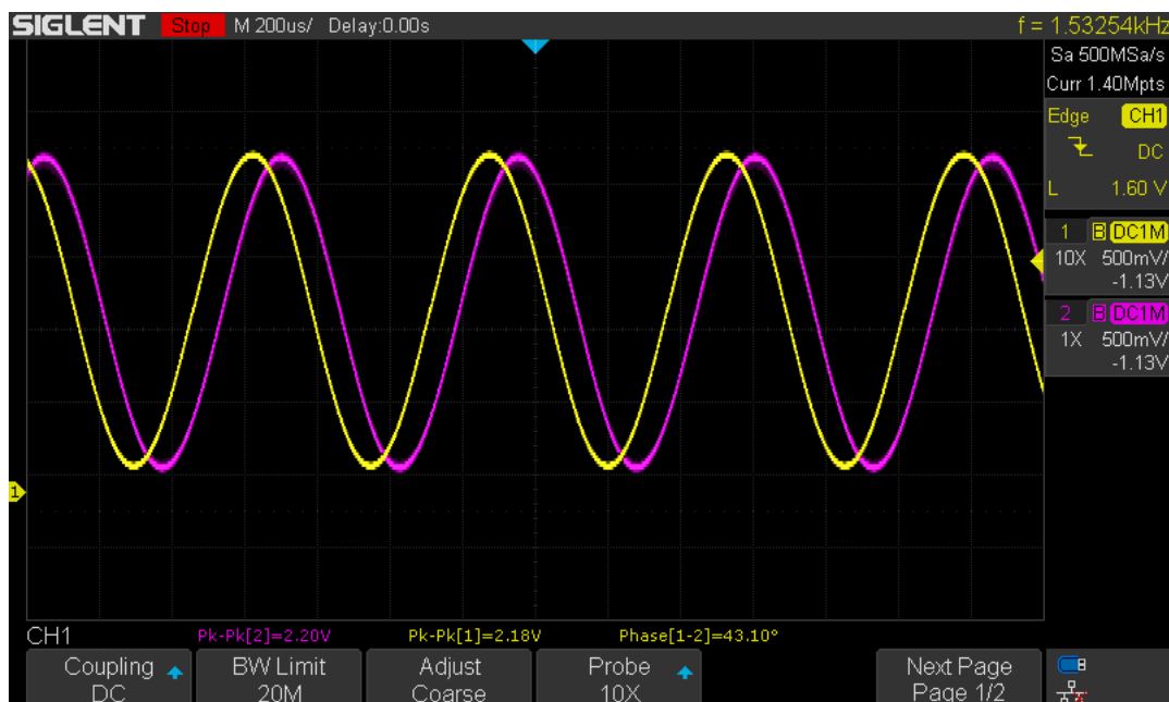
Obr. 7.5: Generovaný (žlutý) a měřený (fialový) signál pro transformační metodu.
