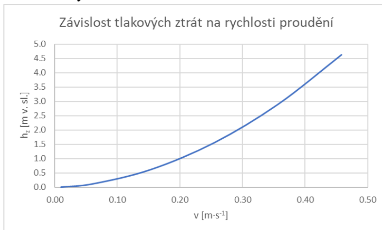
Obr. 4.11: Grafické znázornění závislosti tlakových ztrát na rychlosti proudění
