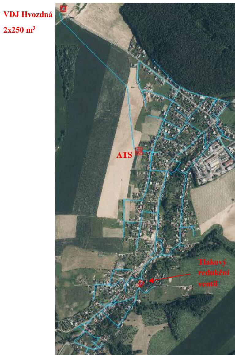
Obr. 4.2 Přehledné schéma topologie vodovodní sítě obce Hvozdná
