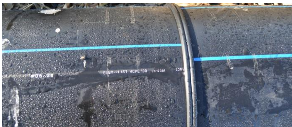
Obr. 4.18: Svar vzniklý svařováním na tupo [22]
