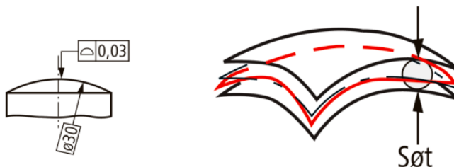
Obr. 27) Geometrické tolerovanie profilu povrchu [10]
