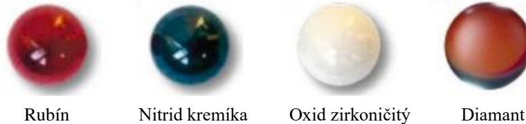
Obr. 40) Materiály meracích guľičiek [21]
