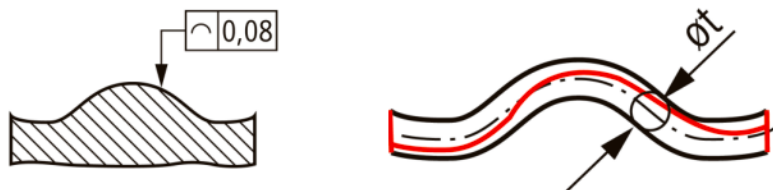
Obr. 26) Geometrické tolerovanie profilu číary [10]
