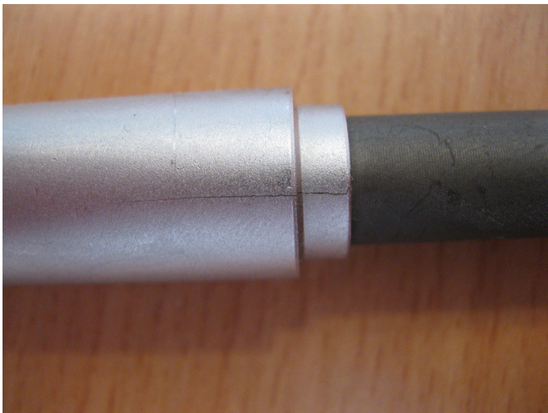
Obr. 2.1 Trhliny na trubce po zalisování válečku
