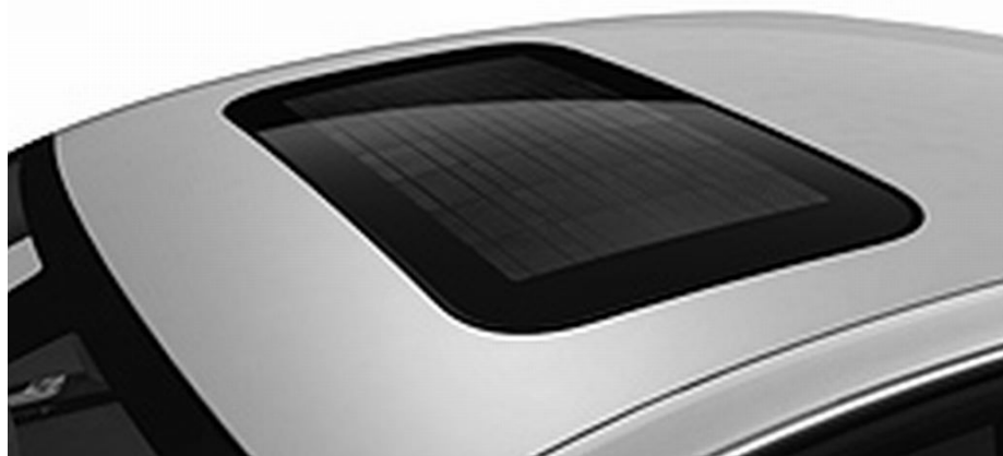
Obr. 23: Pohled na solární panely střešního okna automobilu Audi [17]
