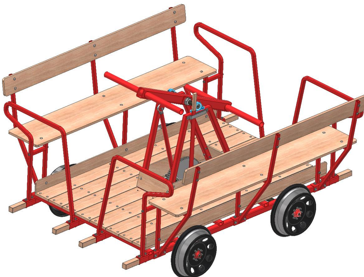
Obr. 2-1 Konstrukce navržené drezíny
