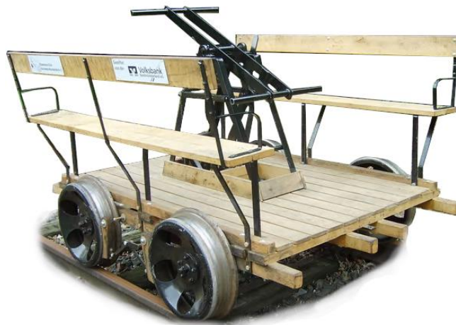
Obr. 1-6 Drezína – dřevěný rám [15] (upraveno)
