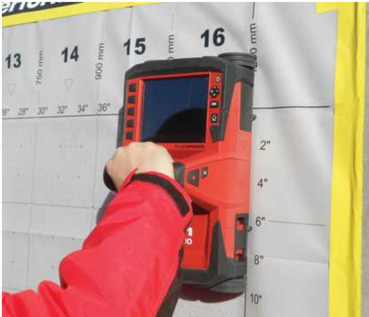
Obr. 8: Sonda přístroje HILTI PS 1000 při plošném skenování železobetonové stěny; sonda se pohybuje po rastru o rozměrech 1200 x 1200 mm. [15]
