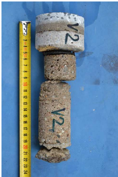
Obr. 33: Jádrový vývrt V2 odebraný z balkonu na východní straně domu v 1. NP
