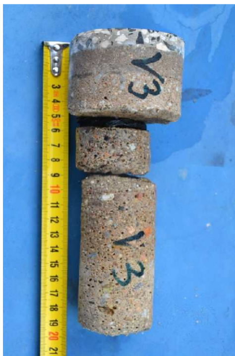
Obr. 34: Jádrový vývrt V3 odebraný z balkonu na východní straně domu v 1. NP.
