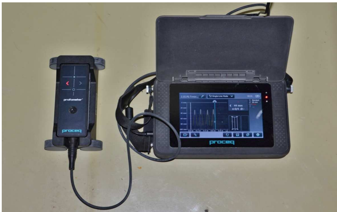
Obr. 7: Profometer PM – 6 s dotykovým displejem a integrovanou sondou. Na sondě lze vidět naváděcí šipku pro přesné zaměření polohy výztuže.
