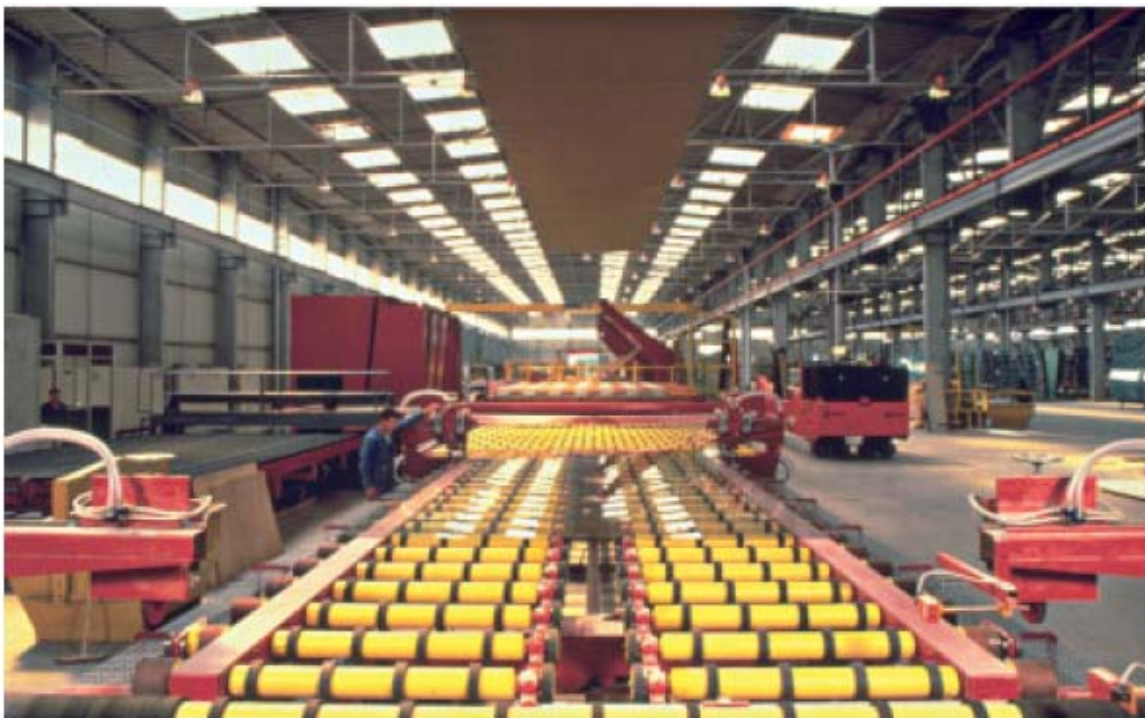
Obr.4.6-6: Vnitřní pohled na linku Float společnosti Saint-Gobain [10]
