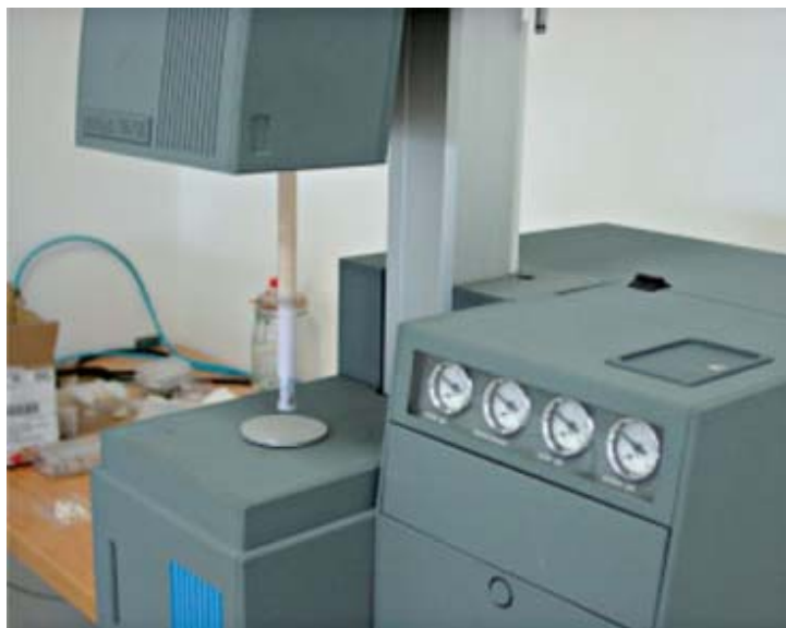
Obr.4.4-3:Dilatometr celkový pohled [10]
