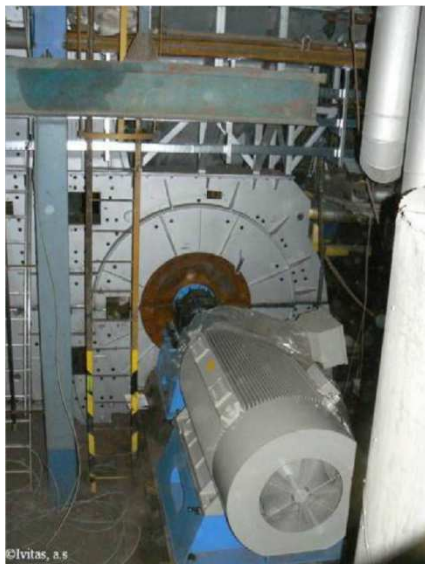
Obr. 2-16 Mlýn s asynchronním motorem řady SIMOTICS 1LA4 [12]
