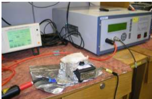
Obrázek 29: Měření dotykového proudu a proudu unikajícího pacientem
