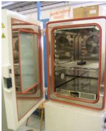
Obrázek 27: Příprava mikrostimulátoru ke kondicionování v klimatické komoře VCV4034
