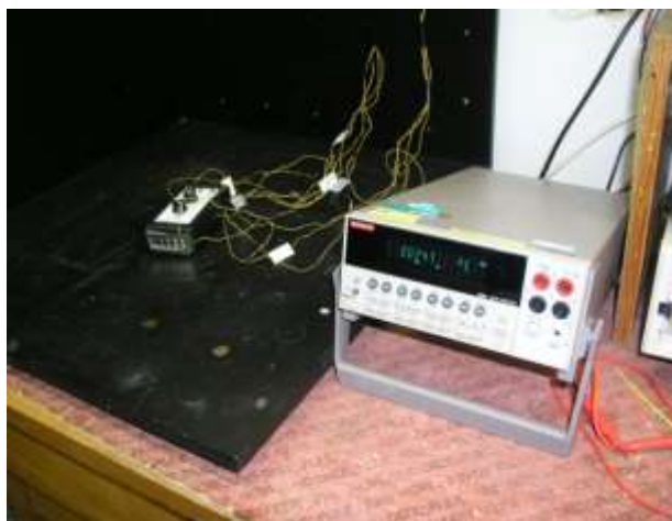
Obrázek 31: Zkouška měřením teplot částí mikrostimulátoru pro zjištění úrovně ochrany před nebezpečnými teplotami
