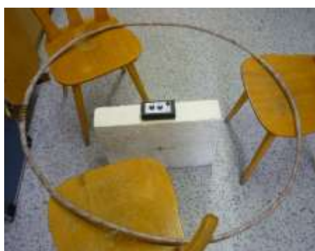
Obrázek 35: Zkouška odolnosti proti magnetickému poli síťového kmitočtu.
