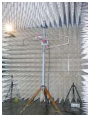
Obrázek 32: Anténa ve stíněné bezodrazové komoře, pracoviště ITC Uherské Hradiště
