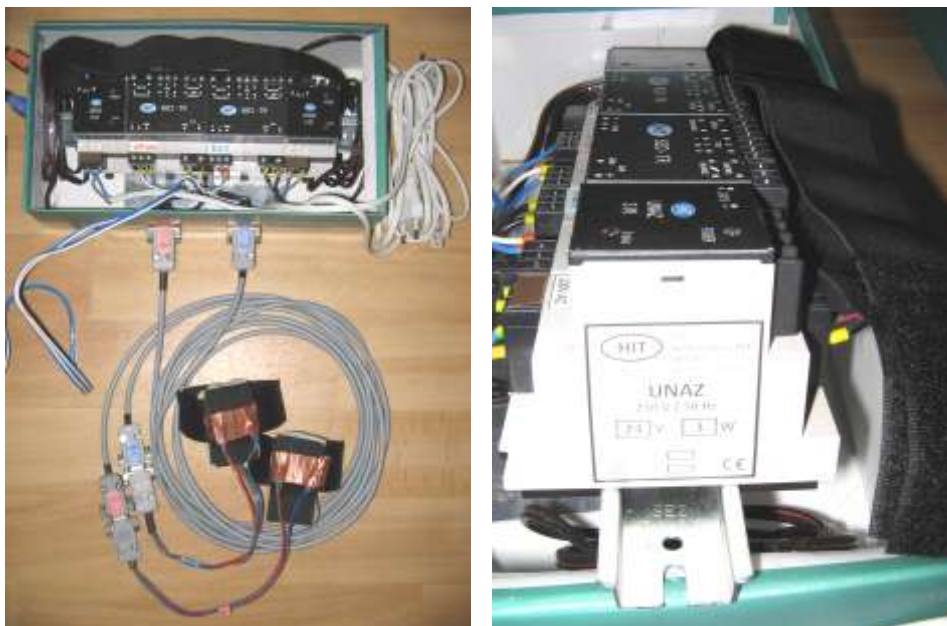
Obrázek 39: Praktická realizace TDS pro měření na koních
