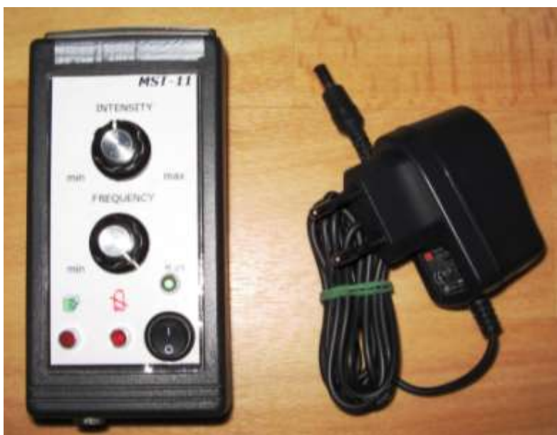
Obrázek 26: Funkční vzorek mikrostimulátoru se síťovým adaptérem
