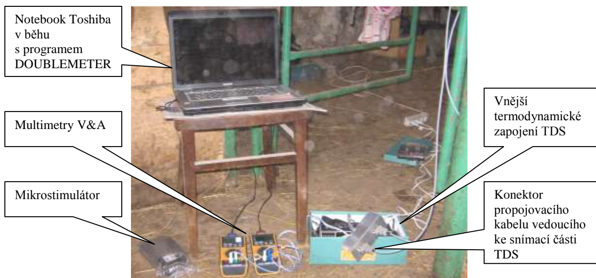
Obrázek 41: Měřicí aparatura (horší kvalita snímku zapříčiněna prašným prostředím stáje)
