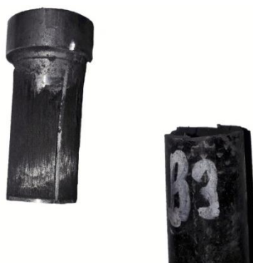
Obr. 14 Vzhled LP vzorku B3, rýha v insertu vznikla při rozebírání spoje
