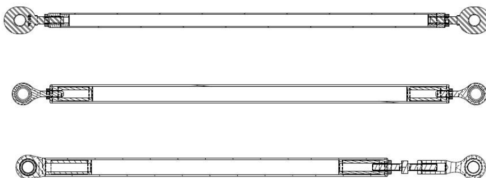
Obr. 4 Typy spojovacích tyčí – nahoře ocelová trubka se svařovaným insertem a rodendy, uprostřed kompozitní trubka s vlepenou vložkou a rodendy, dole kompozitní trubka s oky se sférickými ložisky a šroubem s pravolevým závitem
