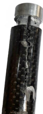
Obr. 16 Prasklina na vzorku C1
