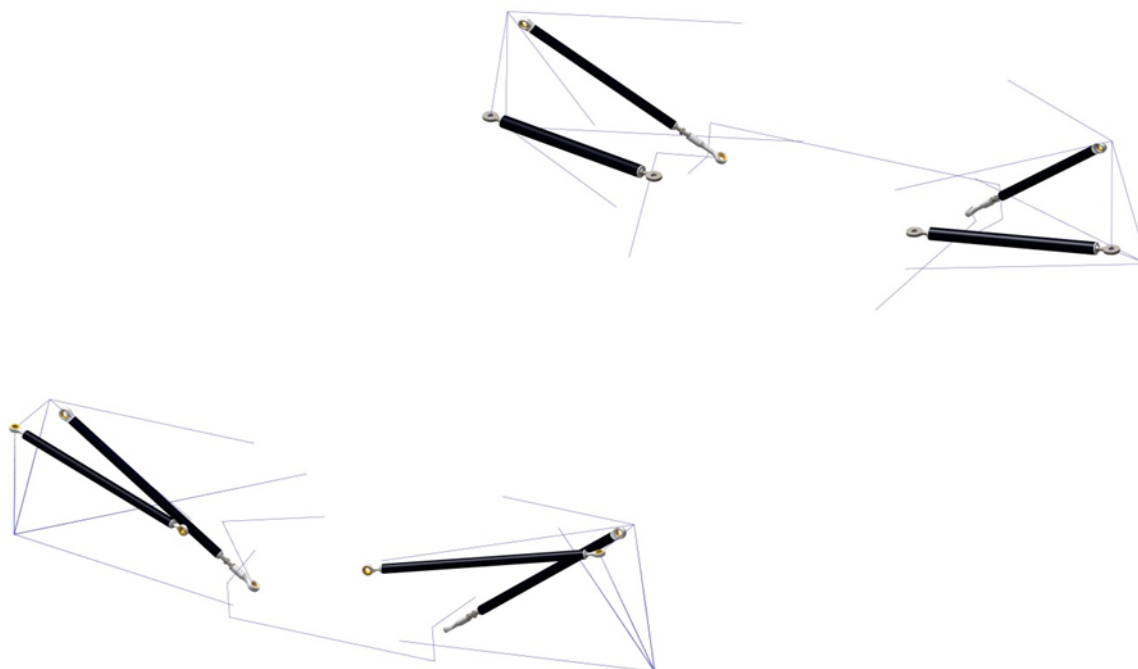
Obr. 27 Navržené spojovací tyče na skeletonu podvozku formule Dragon 7
