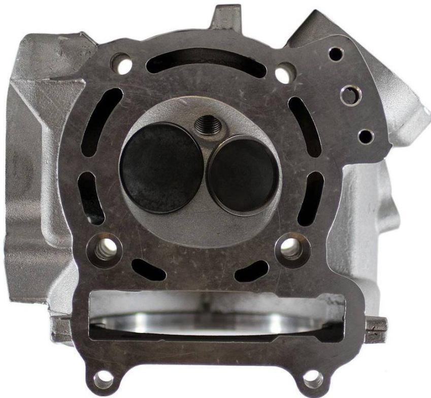
Obrázek 10 - hlava válce Aprilia Leonardo 250 s ventily (10)
