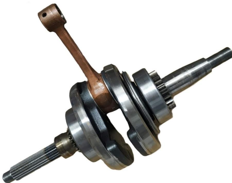
Obrázek 83 - sestava klikové hřídele s ojnici motoru Leonardo 250
