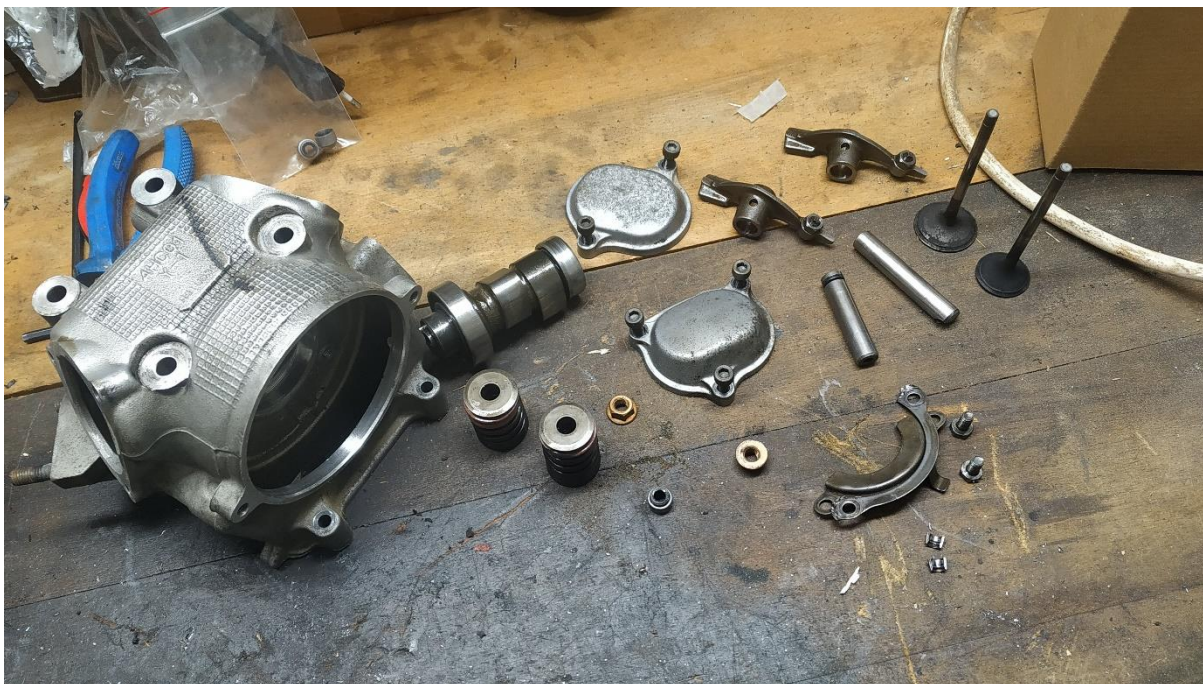
Obrázek 12 - rozložená hlava Aprilia Leonardo 250 se všemi komponentami
