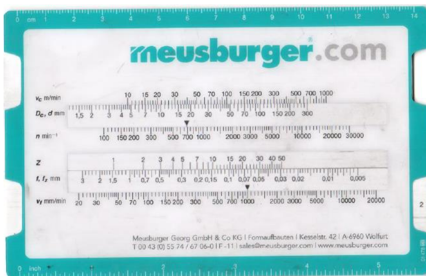
Obr. 20 Převodník používaný pro zjištění posuvové rychlosti.
