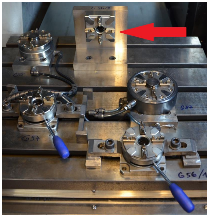
Obr. 18 CNC frézka CT – 600 rozmístění upínačů pro držáky elektrod.
