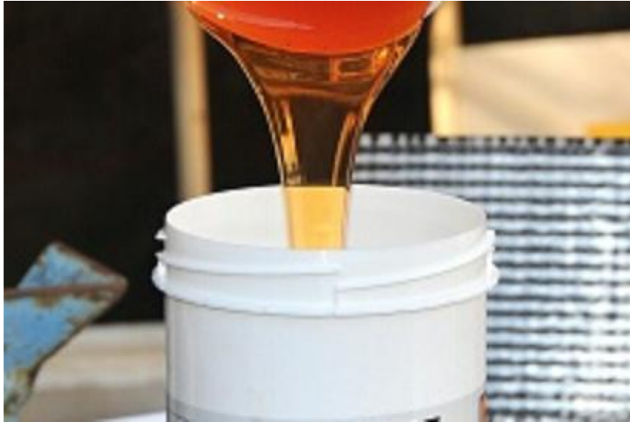
Obr.4: Zalévací pryskyřice na bázi epoxidu a polyuretanu[13]
