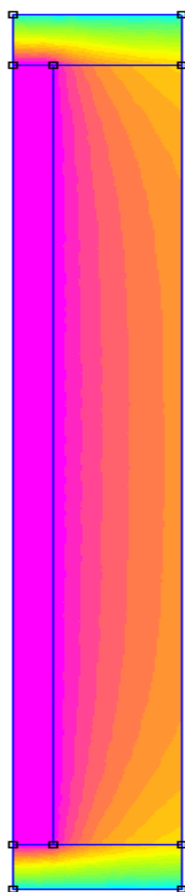
Obrázek 26: Rozložení tepla ve hmotě ER 2074
