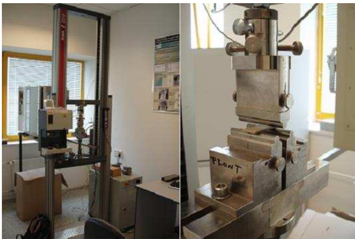
obr. 4.5 – Vlevo zkušební přístroj ZWICK 010, vpravo detail čelistí pro tříbodovou zkoušku ohybem.
