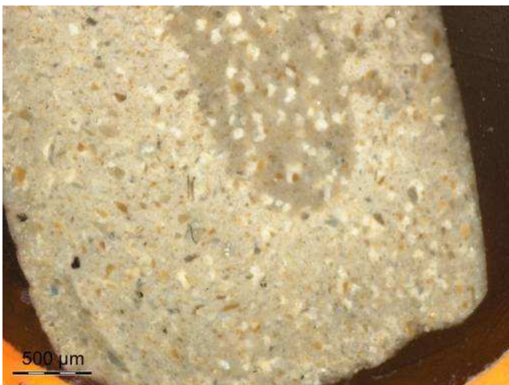
obr. 5.19 – Nábrus vzorku 6 %, 60 °C, vlhko 7 dní ( zvětšení 40x).
