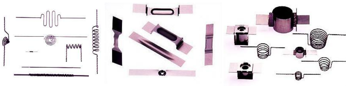
Obr. 3.6 Odporové odpařovací zdroje (drátové, vaničkové a kelímkové) 11
