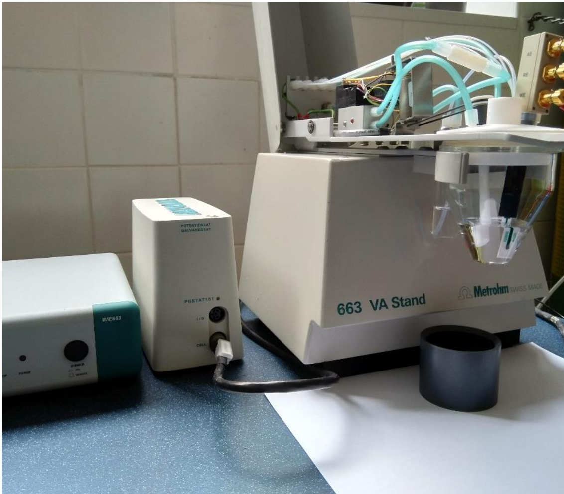
Obrázok 8: Zariadenie 663 VA Stand a Autolab potentiostat od spoločnosti Metrohm
