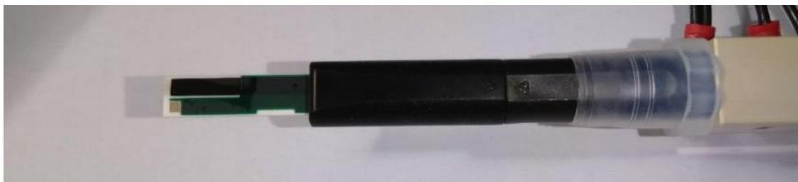
Obrázok 7: scTRACE Gold elektróda (tlačená referentná a pomocná elektróda)
