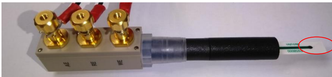
Obrázok 6: scTRACE Gold elektróda (zvýraznená časť s Au mikrovláknom)
