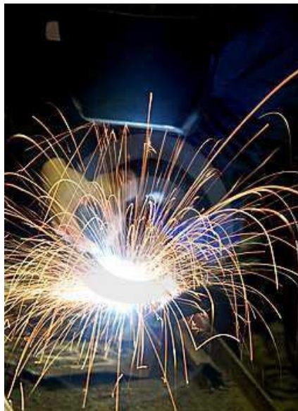
Obr. 3 Svařování v ochranné atmosféře [7]
