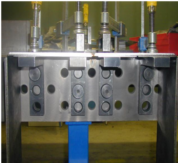
Detail upnutí komory před svařením za použití svěrek
