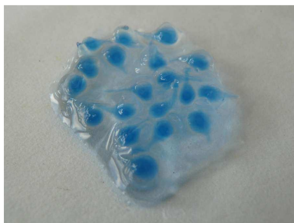
Obr. 21 Chitosanové perly s obsahem \text{Cu}^{2+} iontů po sorpci z roztoku \text{CuCl}_2
