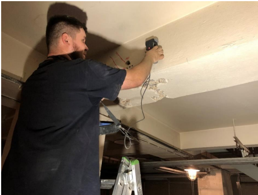
Obr. 1: Použití přístroje Profometer PM-630
