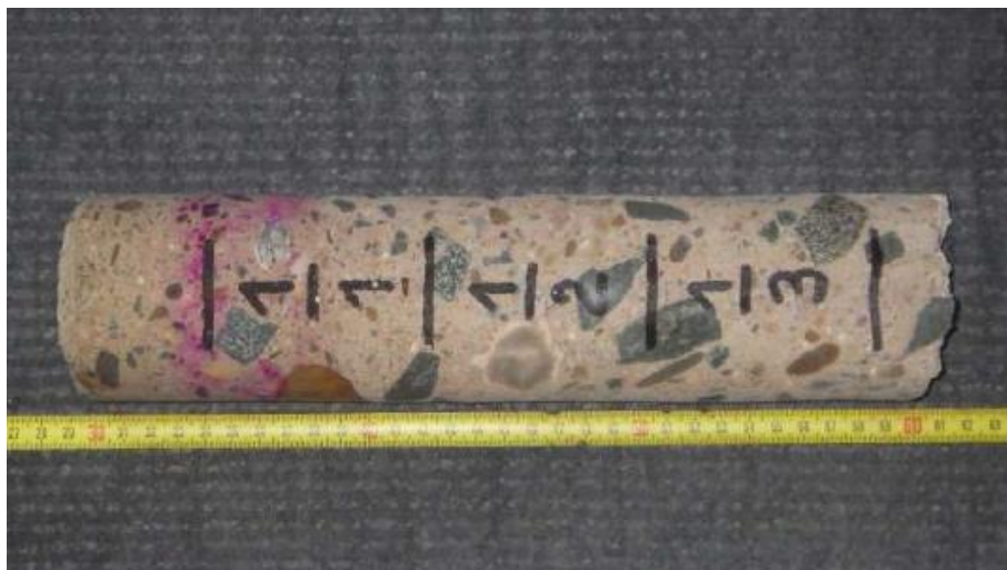
Obr. 5: Příklad odebraného vzorku zachycující provedenou zkoušku hloubky karbonatace a vyznačení míst odběru zkušebních těles určených ke stanovení pevnosti betonu v tlaku.
