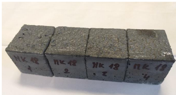
Obr. 4. 4: Nařezaný trámeček na čtyři části o rozměru 40 \times 40 \times 160 mm
