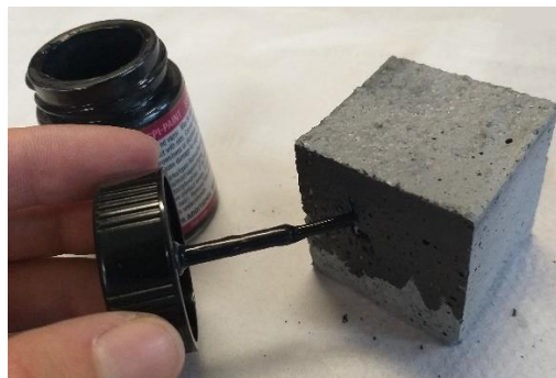
Obr. 4. 5: Natírání dvou protilehlých stran vodivou uhlíkovou pastou
