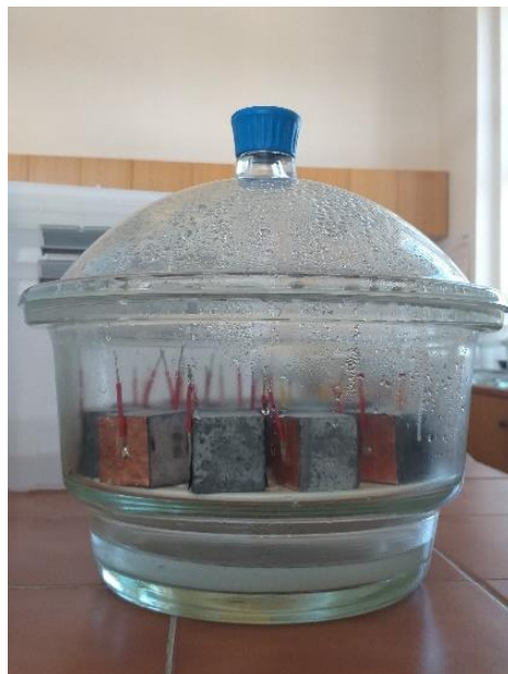
Obr. 4. 7: Uložení vzorků v exsikátoru
