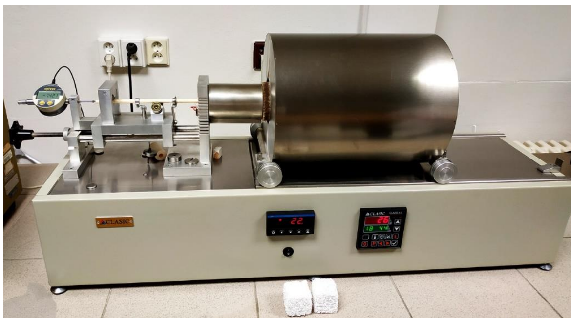
Obr. 13: Dilatometr od firmy CLASIC CZ s.r.o. pro měření teplotní roztažnosti
