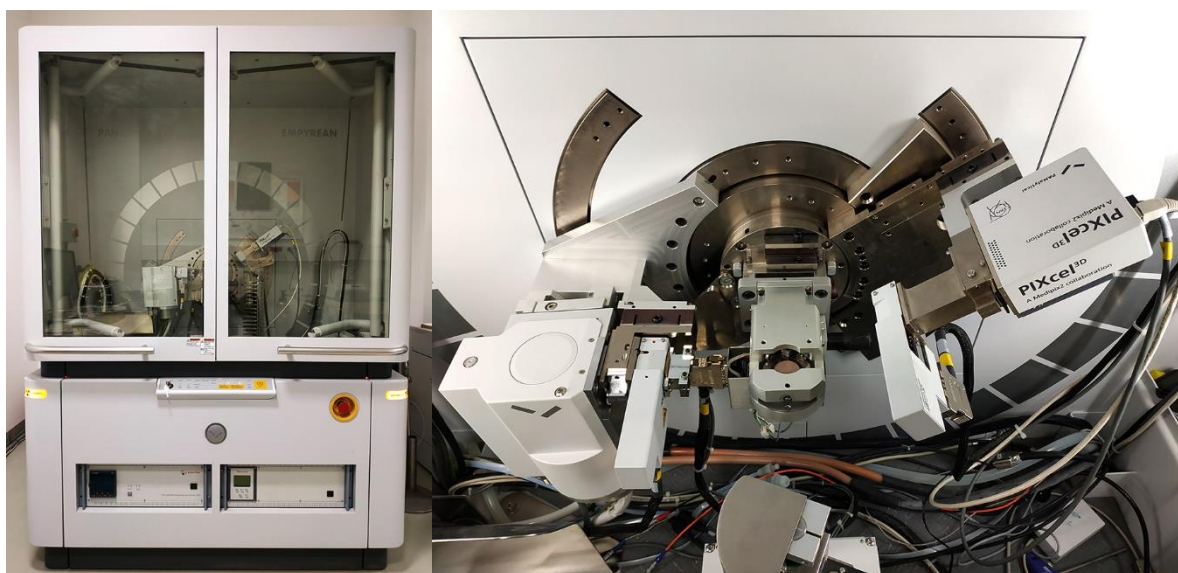
Obr. 10: Difraktograf PANalytical Empyrean XRD (vlevo); detail zdroje záření, detektoru a umístěného vzorku (vpravo)
