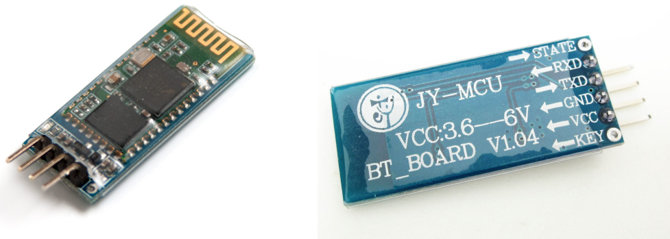
Obrázek 3.6: Serial Bluetooth modul použitý na bezdrôtovú komunikáciu medzi FITkitom a mobilným telefónom s OS Android.
