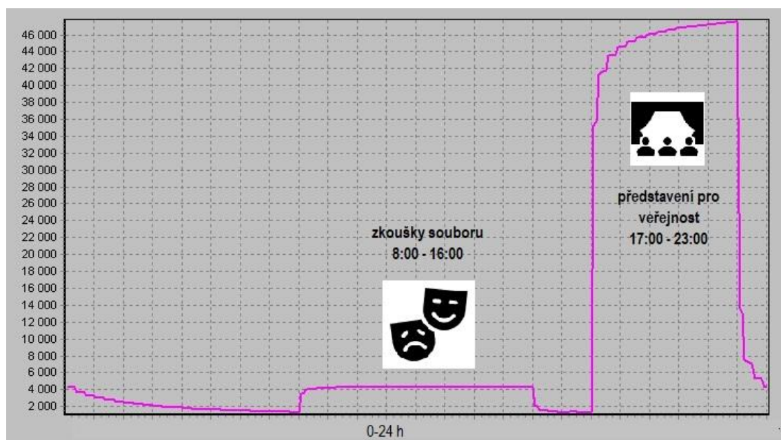
Obrázek 17: Graf tepelné zátěže pro jeviště a hlediště
