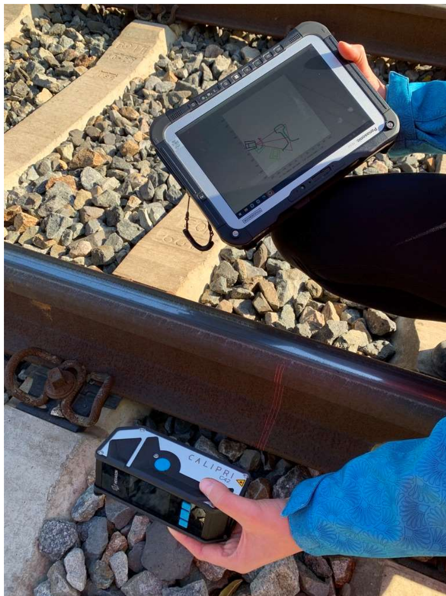
Obrázek 21: Detail měření pomocí Calipri C42 [autor]
