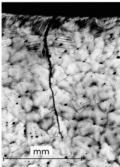
Obr. 2.4 Šíření magistrální trhliny
