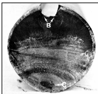
Obr. 2.7 Únavový lom hnacího hřídele z nikel chrom molybdenové oceli B – iniciace trhliny v drážce C – nestabilní lom
