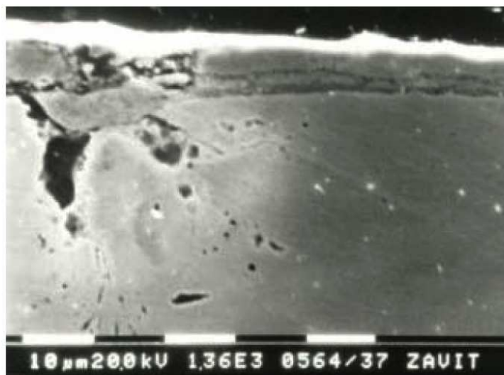
Obr. 3.2 Struktura vzorku firmy Fabory snímaná elektronovým mikroskopem
