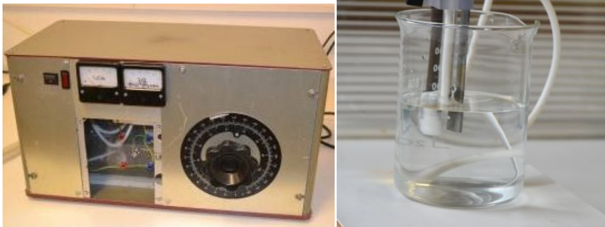
Obrázek č. 4: Zdroj stejnosměrného napětí (vlevo) a použitá aparatura s detailním výřezem konce tryskové elektrody (vpravo)
