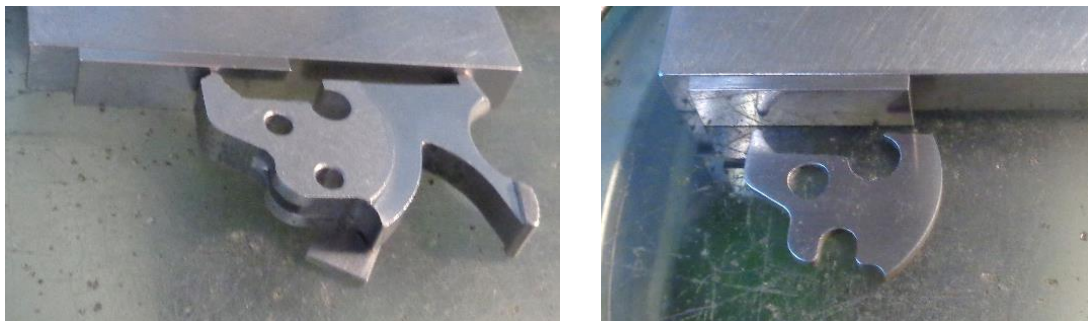
Obr. 32) a) Podložení koncovou měrkou b) Speciální podložka
