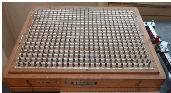
Obr. 24) Sada válcových kalibrů 1,00 – 5,99 mm
