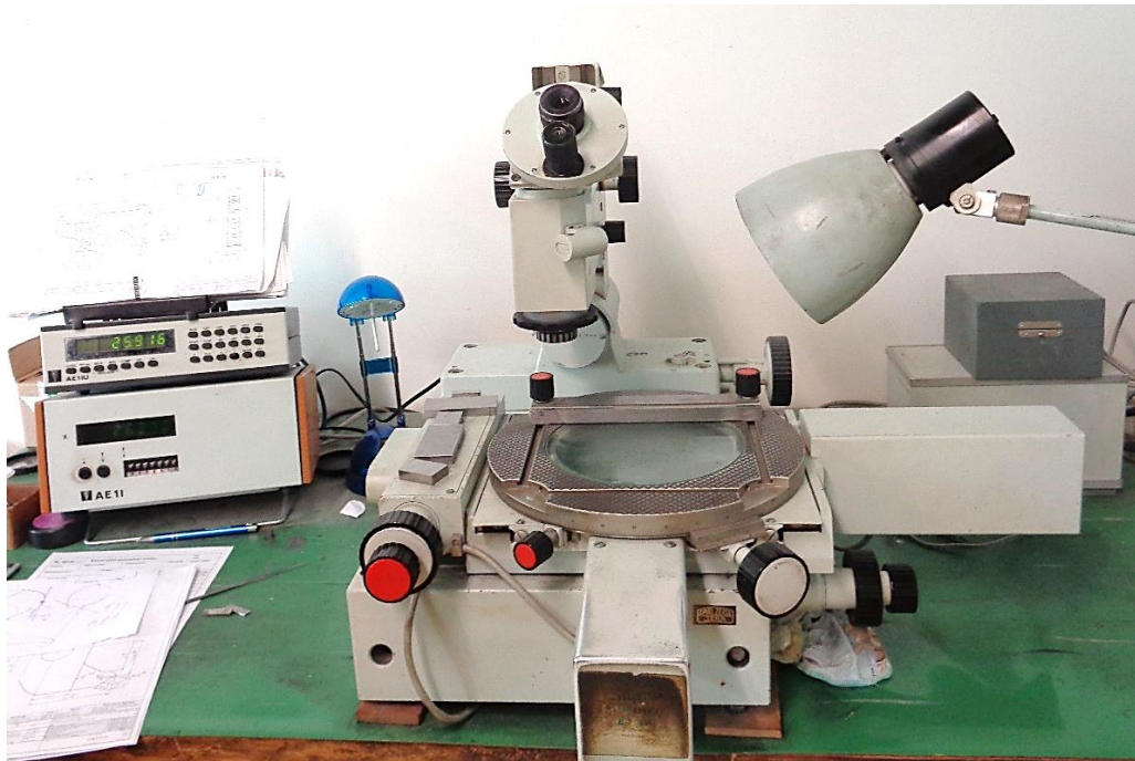
Obr. 23) Dílenský mikroskop Carl Zeiss
