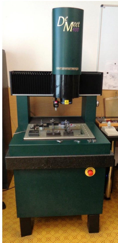
Obr. 27) Souřadnicový měřicí stroj DeMeet 400
