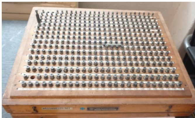
Obr. 25) Sada válcových kalibrů 6,00 – 9,99 mm
