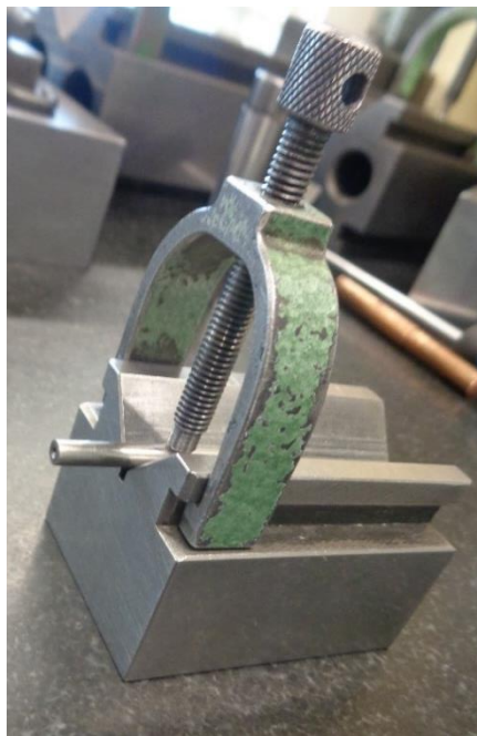
Obr. 29) Prizma společně s válcovým kalibrem
