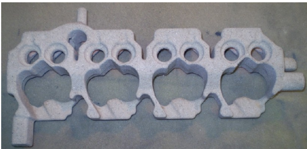
Obr. 45: jádro hlavy motoru
