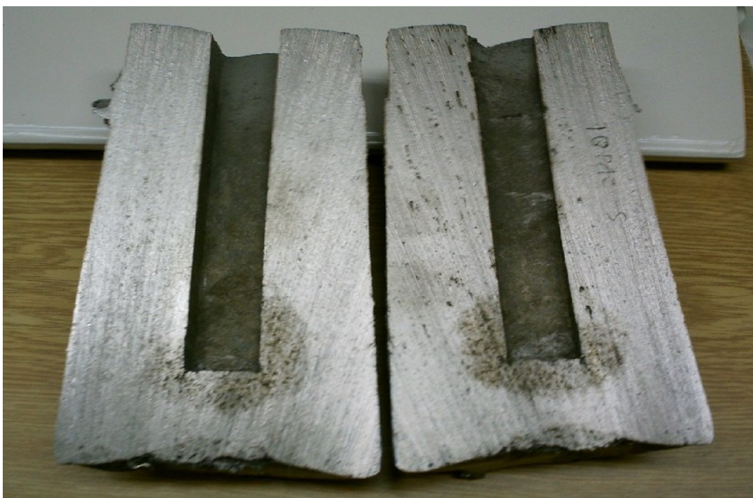
Obr. 20: otvor po jádru s pojivem TOPAZ SPECIÁL
