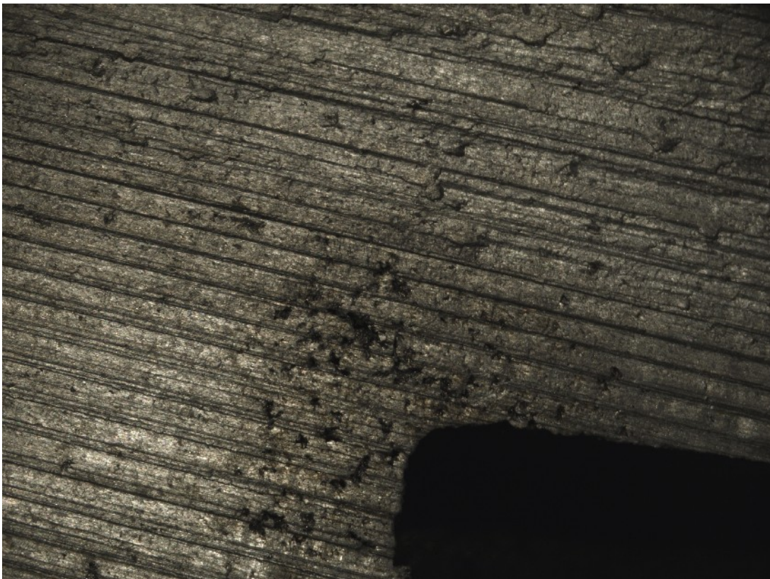
Obr. 24: mikrostaženiny v okolí otvoru po jádře s pojivem TOPAZ I
