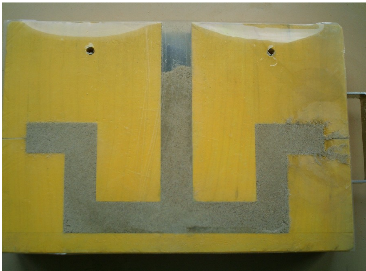
Obr. 27: vstřelená směs s pojivem TOPAZ SPECIÁL při vstřelovacím tlaku 0,4 MPa
