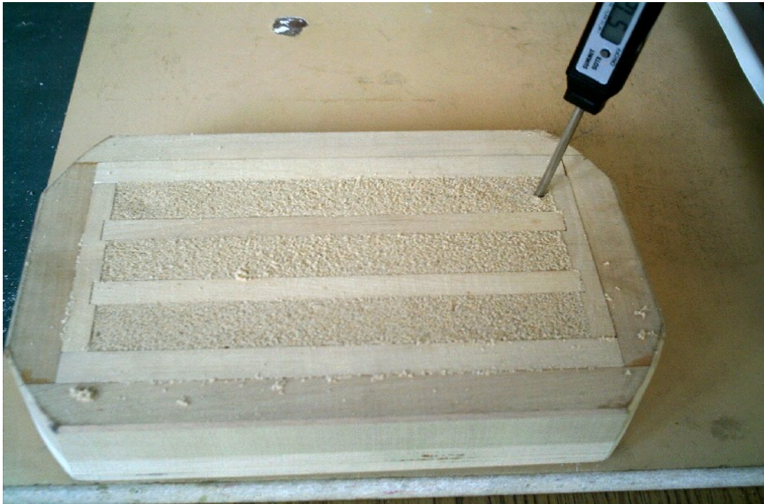
Obr. 8: jaderník pro mikrovlnné vytvrzování se zapěchovanými jádry a teploměrem SUMMIT SDT8
