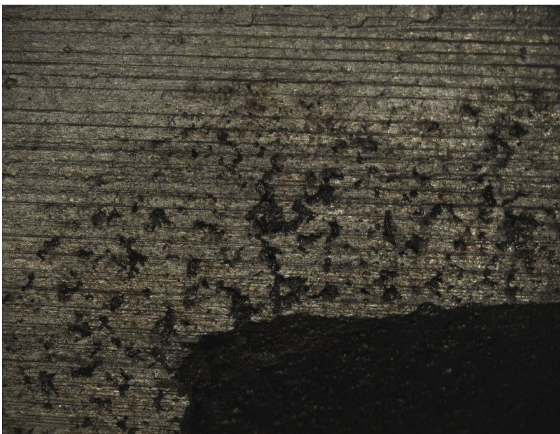
Obr. 25: mikrostaženiny v okolí otvoru po jádře s pojivem KOŽNÍ KLIH K-2
