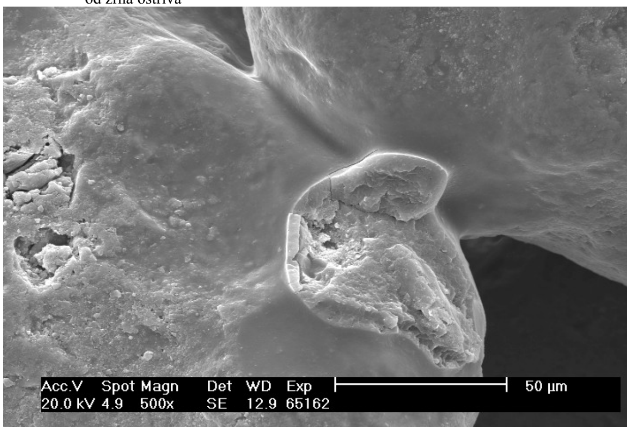
Obr. 38: stopa po adhezním odtržení pojivového můstku od zrna ostřiva a pojivový můstek mezi zrny ostřiva
