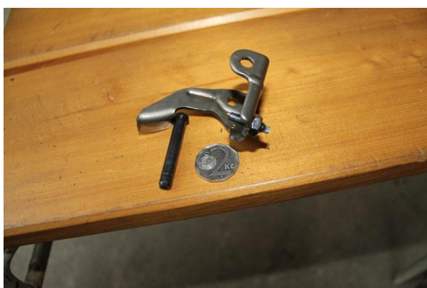
Obr. 3.12 Vahadlo ventilu s jeho čepem motoru Honda GXV 160
