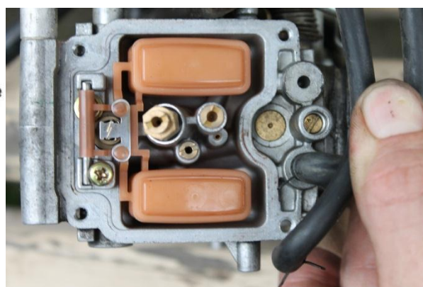
Obr. 4.9 Plováková komora s plovákem, tryskami a vpravo šroubem volnoběžné směsi
