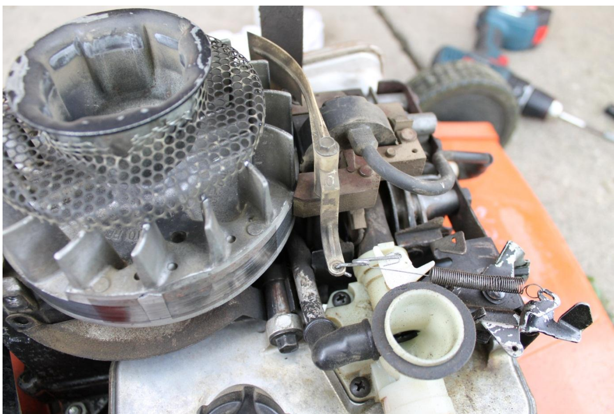
Obr. 4.12 Jednoduchý karburátor se vzduchem ovládaným regulátorem otáček
