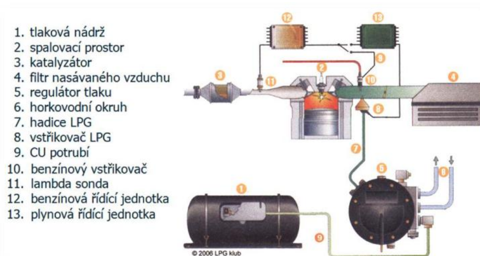
Obr. 6.4 Schéma systému se sekvenčním vstřikováním LPG [14]
