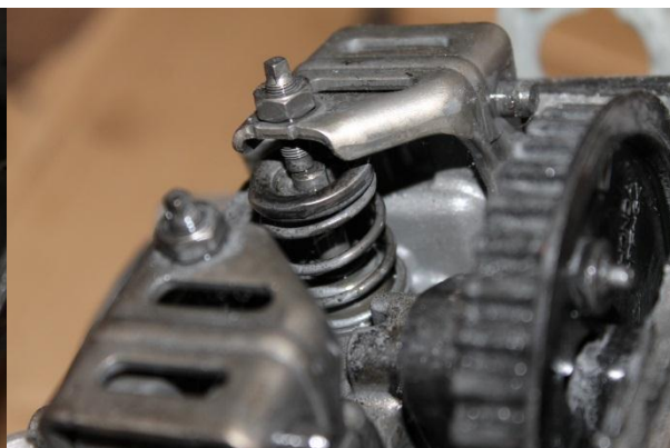
Obr. 3.11 Vahadlo ventilu se seřizovacím šroubkem
