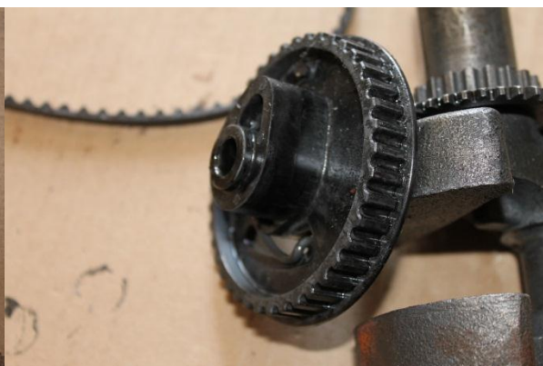
Obr. 3.9 Plastové převodové kolo a vačka
