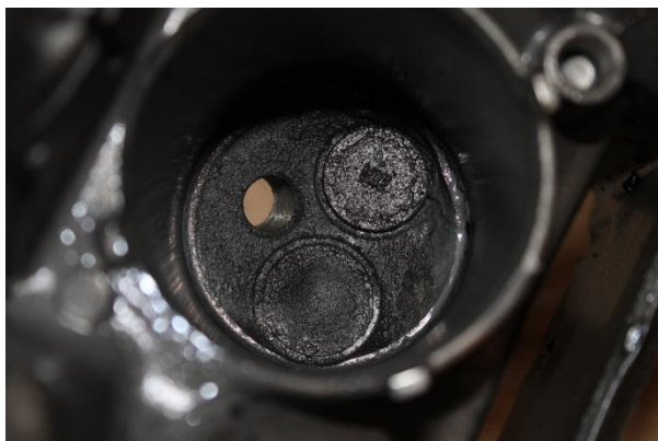
Obr. 3.10 Spalovací prostor motoru s rozvodem OHC
