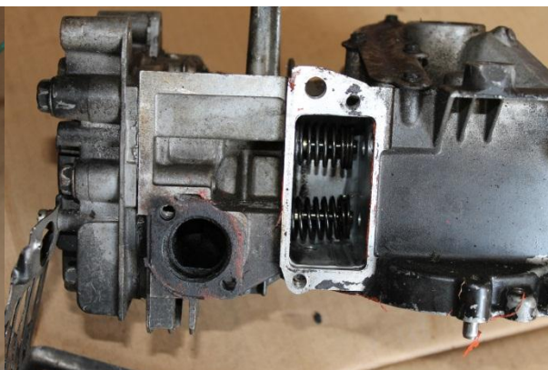
Obr. 3.3 Pohled na otvor pro seřizování ventilové vůle
