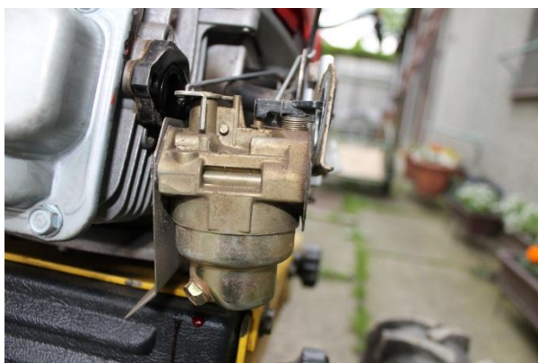
Obr. 4.5 Vyspělejší karburátor s plovákovou komorou motoru Honda GCV 160
