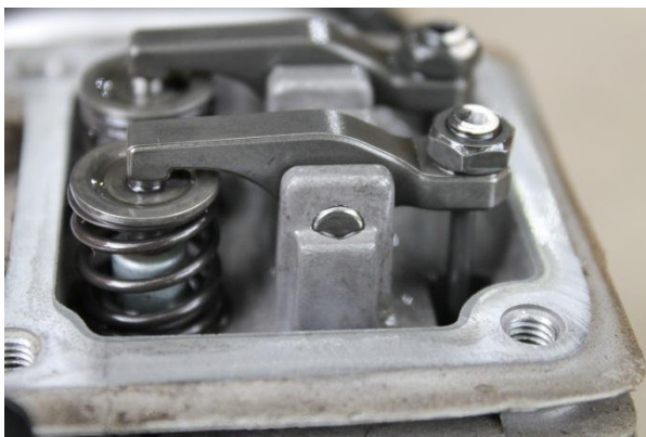
Obr. 3.6 Uspořádání OHV rozvodu v hlavě válce Obr. 3.7 Vahadlo ventilu motoru Subaru 33,5cm 3
