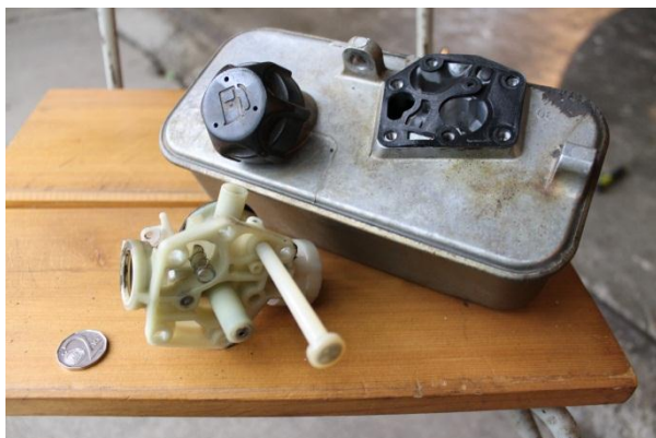
Obr. 4.2 Součásti karburátoru pro motor s konstantními otáčkami
