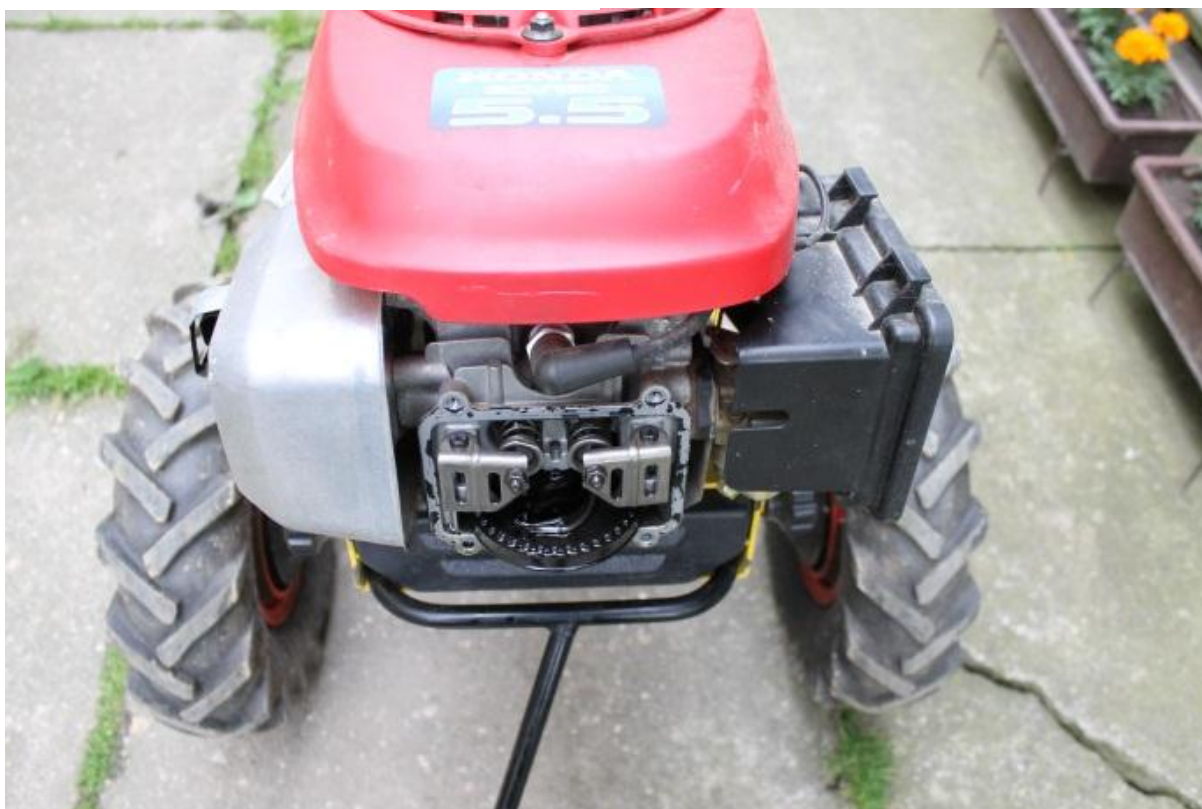
Obr. 3.14 Přístupnost ventilového OHC rozvodu
