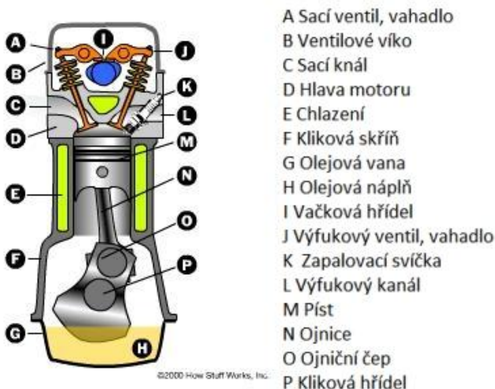
Obr. 2.3 Konstrukce čtyřdobého motoru [3]
