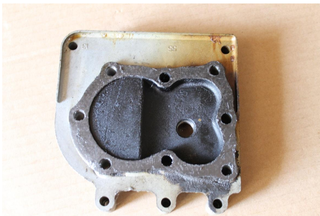
Obr. 3.1 Komplikovaný tvar spalovacího prostoru motoru s SV rozvodem
