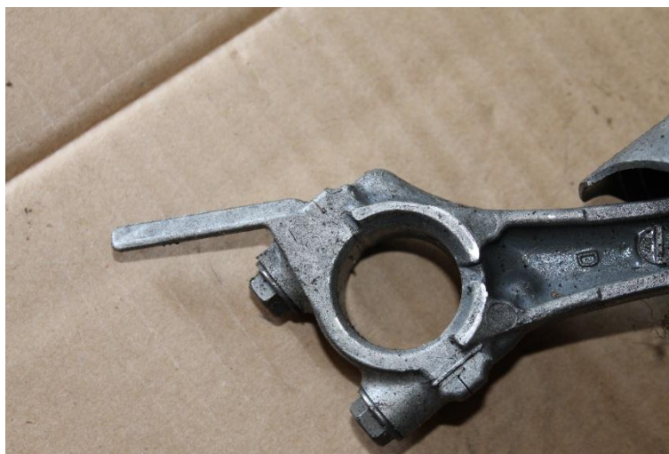
Obr. 5.1 Nálitek ojnice čtyřdobého motoru, tzv. lžice
