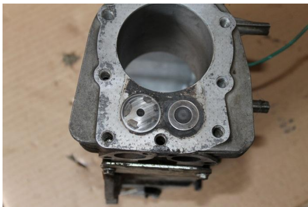
Obr. 3.2 Umístění ventilů vedle válce, vlevo sací ventil
