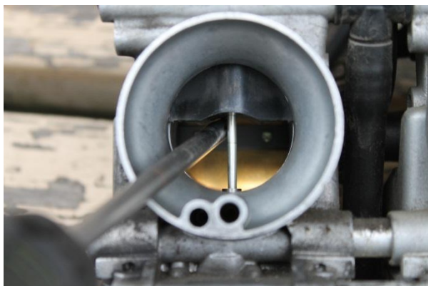
Obr. 4.10 Difusor se vzdušníky, podtlakovým šoupátkem a škrticí klapkou
