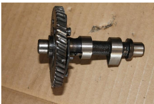
Obr. 3.4 Vačková hřídel motoru s OHV rozvodem
