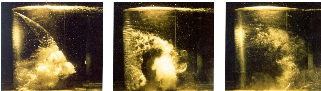
Obr. 4 Snímky zobrazujúce vznik, separáciu a zánik kavitačného oblaku na podtlakovej strane hydraulického profilu. Profil vibruje s frekvenciou 5,8Hz a amplitúdou \pm 5^\circ . Uhol nábehu je 5^\circ a stredná hodnota \sigma = 1,1 [2]
