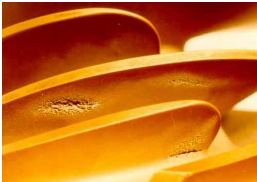
Obr. 10 Kavitačná erózia lopatky čerpadla [2]
