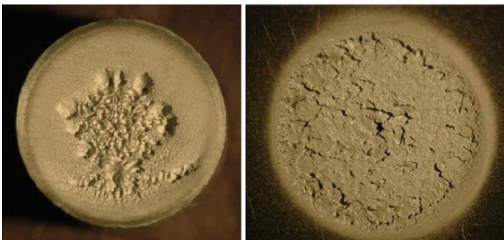
Obr. 14 Charakter erodovaného povrchu vzorky priamej (vľavo) a nepriamej metódy (vpravo)
