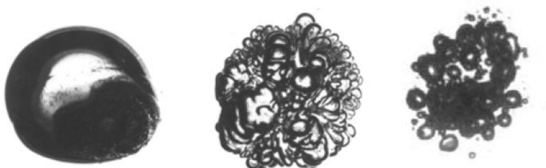
Obr. 9 Fotografie zobrazujúce implóziu kavity v glyceríne pred a po kolapse a odpružení [2]
