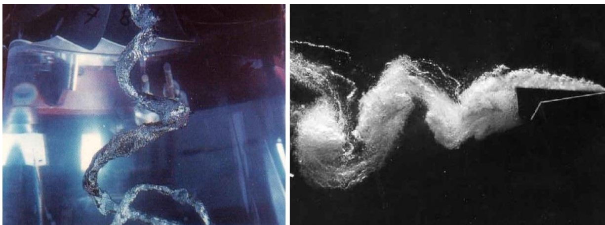
Obr. 5 Vírová kavitácia za obežným kolom Francisovej turbíny a vizualizovaná Karmánová vírová cesta [2]
