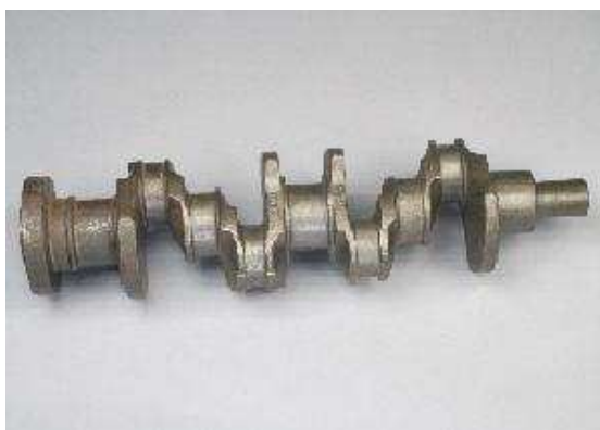
Obr. 13 – Odlitek kličového hřídele [13]
