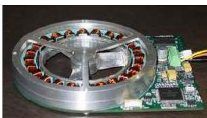
Obr. 4 - Vertikální motor robotu Starbug.
