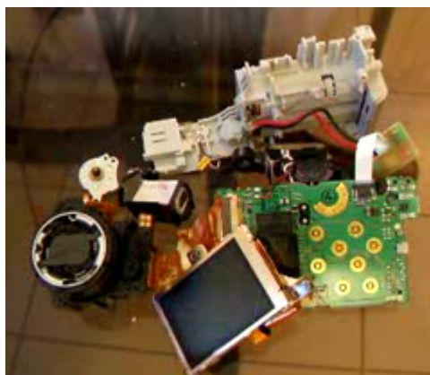
Obr. 37 - Rozebraný fotoaparát Canon A430 (převzato z [20]).
