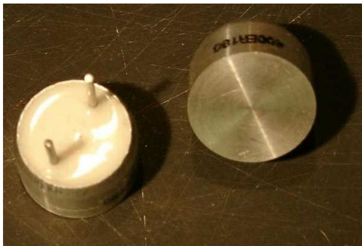
Obr. 5 - Miniaturní čidla sonarů.
