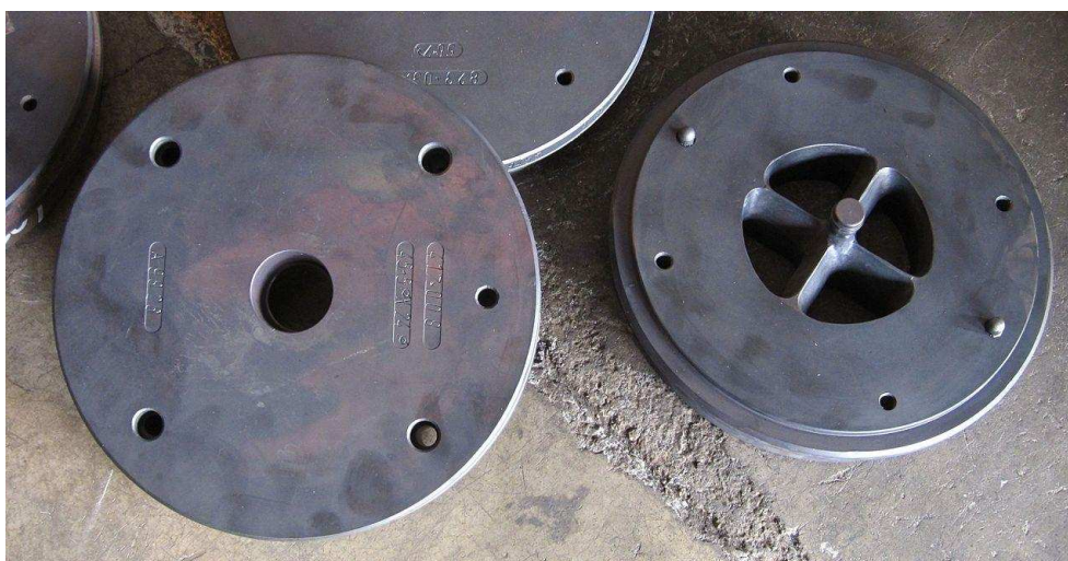
Obr. 4.3 Příklad dvojdišné hliníkové matrice [23].
