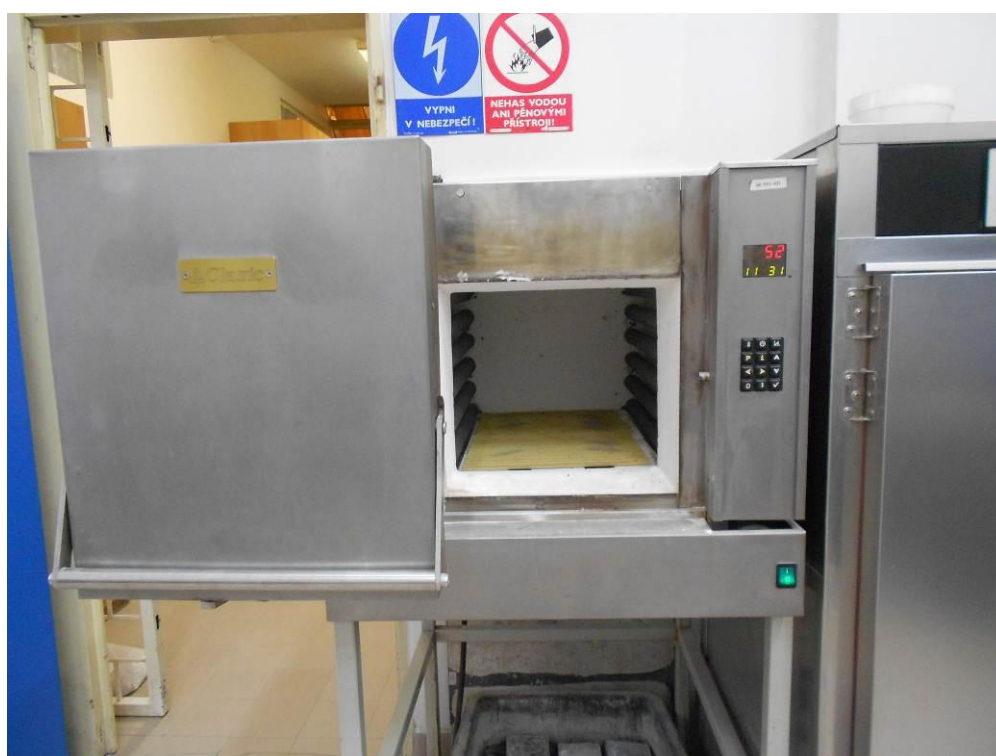
Obrázek 31: Muflová pec použitá pro teplotní zatěžování vzorků
