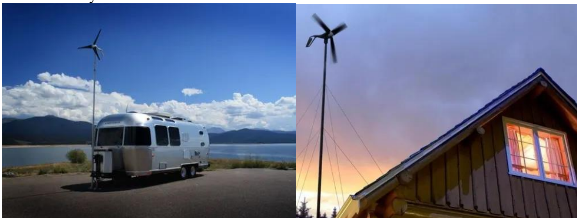
Obrázek 5.6 Větrná turbína Air 40 generující elektrickou energii pro karavan a chatu [58]
