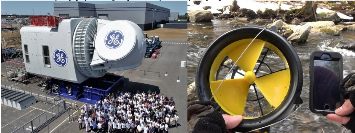
Obrázek 2.1 Velká (Haliade-X) [16] a malá (Waterlily) turbína [17]
