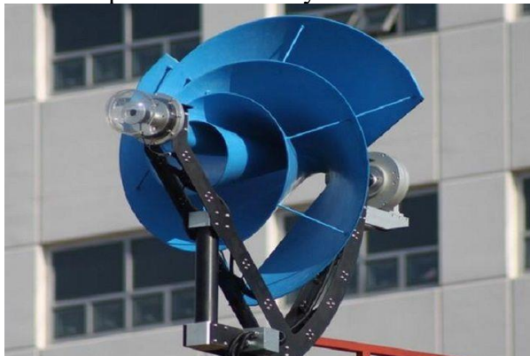
Obrázek 2.12 Větrná turbína Archimedes [30]
