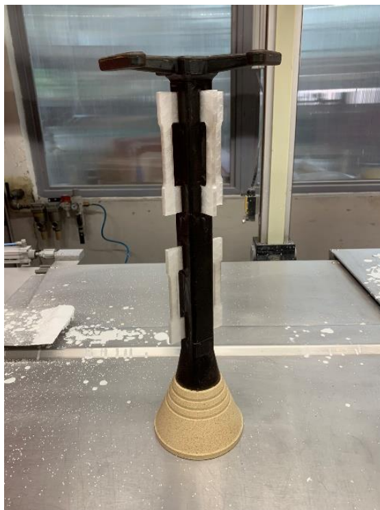
Obr. 25 umístění tyček ve spodní a horní části formy
