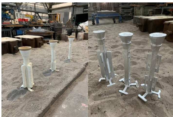
Obr. 45 Vlevo skořepiny připravené na proces odlévání, vpravo stromečky po odstranění skořepiny
