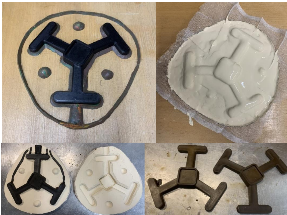
Obr. 41 Vytisknutý model podstavce před (vlevo nahoře) a po (vpravo nahoře) nanesení lukoprenu. Rozdělaná forma po nalití vosku (vlevo dole), hotové podstavce z vosku po odstranění vtokové soustavy (vpravo dole).
