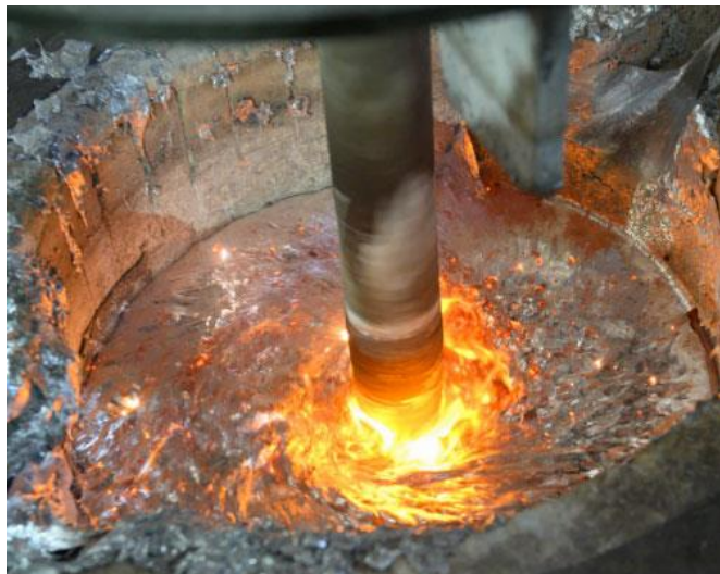
Obr. 15 Vlevo schéma rotačního odplyňovacího zařízení. Vpravo proces odplyňování rotačním zařízením [4], [5]
