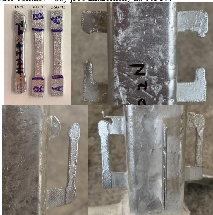
Obr. 59 Vady odlitků tyček o tl. stěny 2 mm při teplotě skořepiny 18 °C
