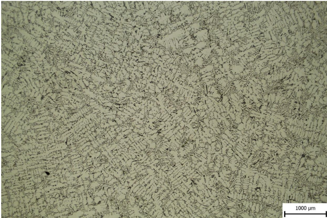
Obr. 79 Vzorek 1055N zcela bez mikrostaženin, původní zvětšení 50x
