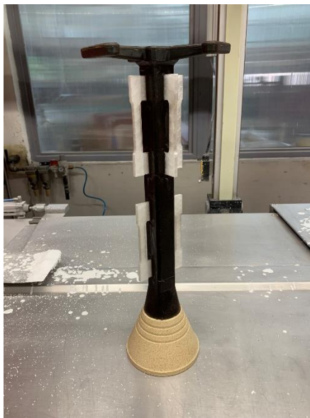
Obr. 43 Zkompletovaná vtoková soustava s přilepenými tyčkami z polycastu
