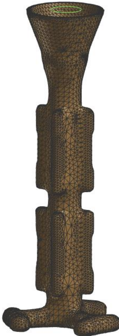
Obr. 27 Vygenerovaná FEM síť skořepiny o tloušťce 8 mm
