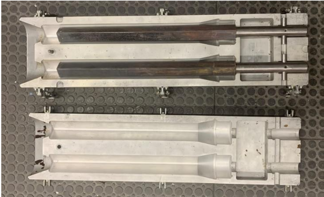
Obr. 42 Rozložená forma pro zhotovování voskových vtokových kůlů
