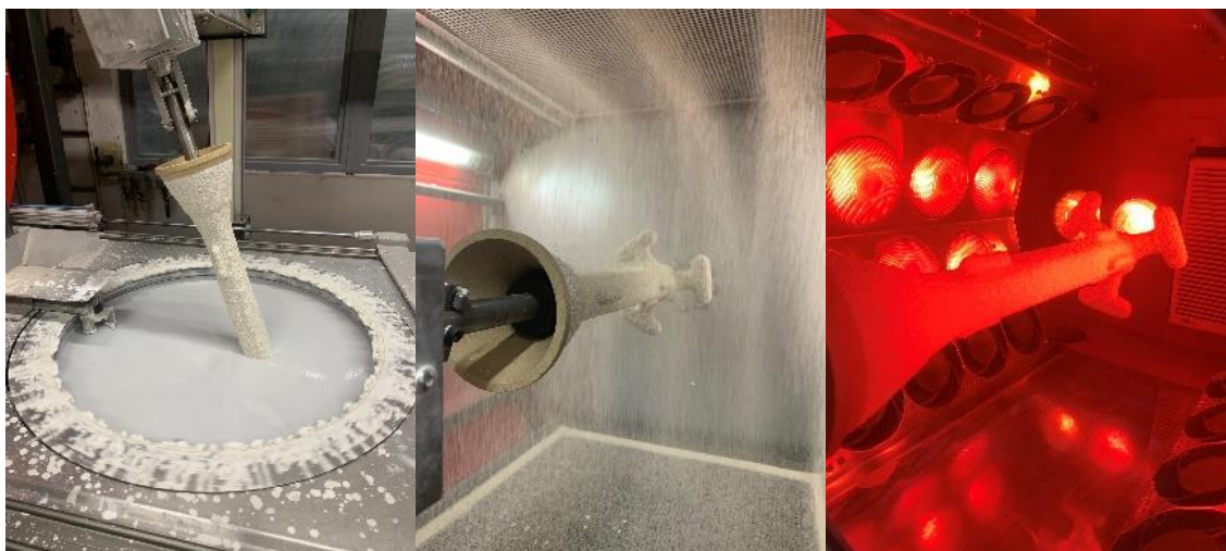
Obr. 44 Proces výroby zpevňujících obalů. Vlevo máčení v suspenzi, uprostřed posyp molochitovým ostřivem, vpravo sušení obalu.
