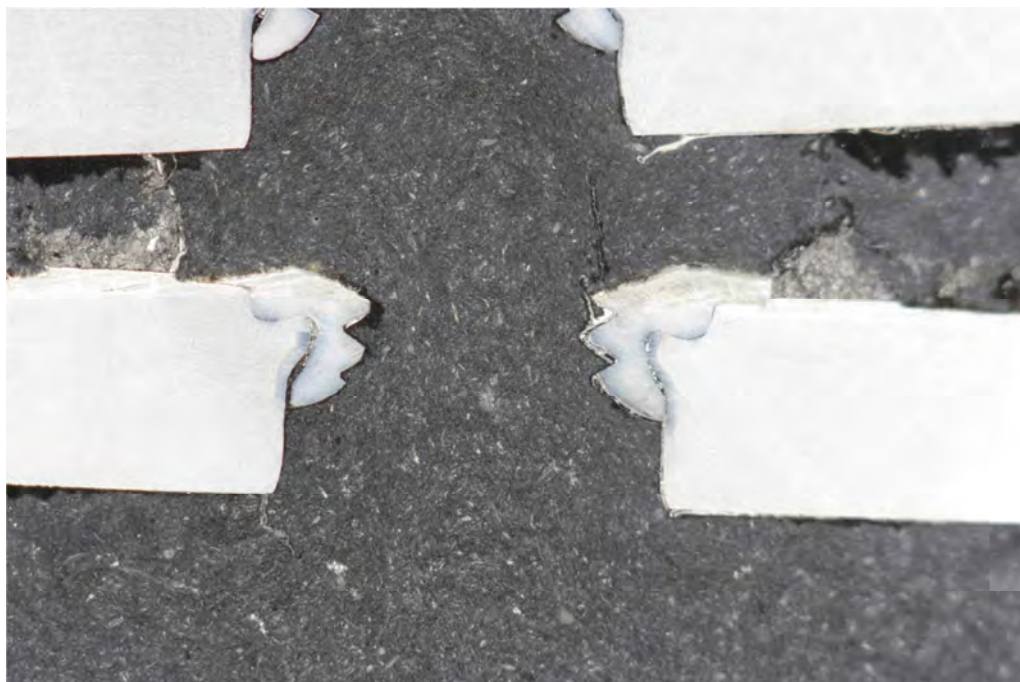
Makro - vzorek č. 4 N 2 – výchozí otvor 4,24 mm
