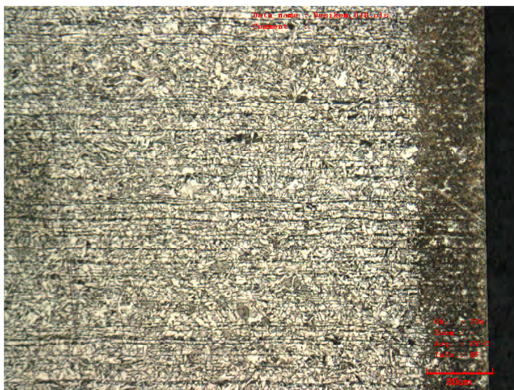
Řezná hrana na metalografickém vzorku O 2 – zvětšení 20 x
