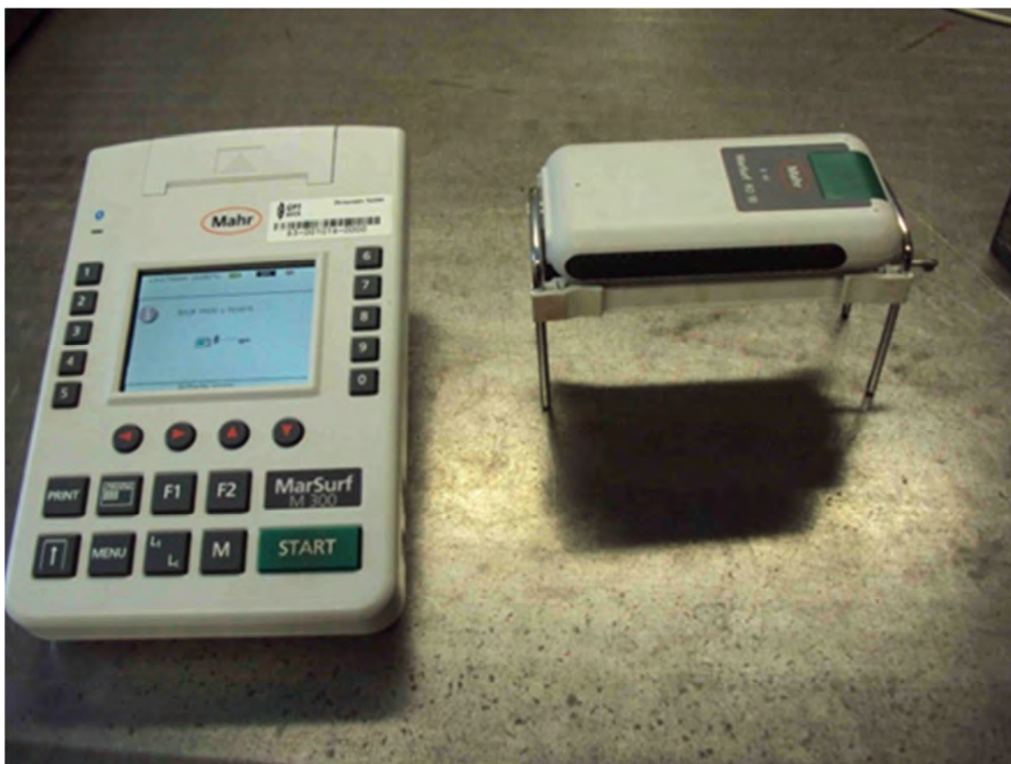
Drsnoměr MarSurf M300 (vlevo) s posuvovou jednotkou MarSurf RD 18 (vpravo) [1]
