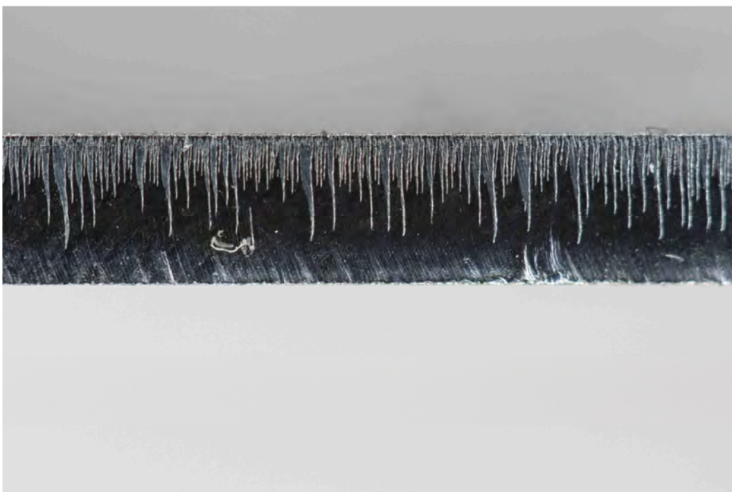
Povrch 01 vzorku u oxidačního řezání
