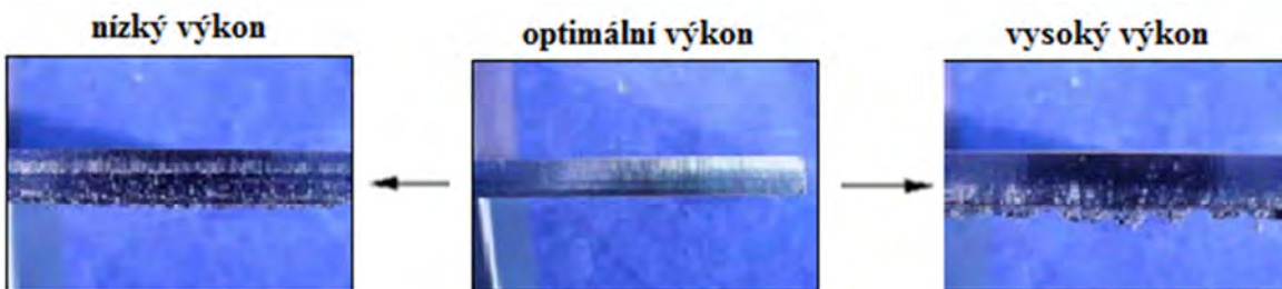
Obr. č. 34 Vliv výkonu - tenký materiál [2]
