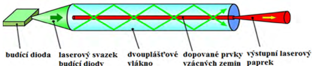
Obr. č. 18 Princip vlákňového laseru [1]
