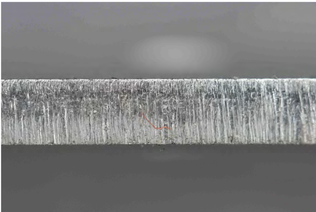
Povrch 03 vzorku u tavného řezání
