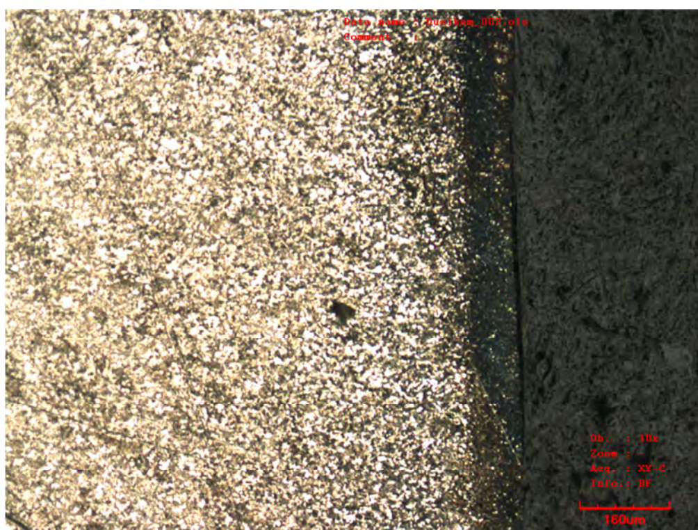
Řezná hrana na metalografickém vzorku N 2 – zvětšení 10x
