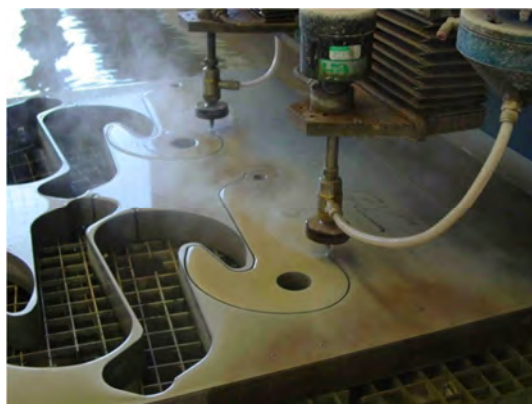
Obr. č. 7 Řezání vodním paprskem [22]
