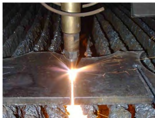
Obr. č. 4 Hořák pro strojní řezání [5]
