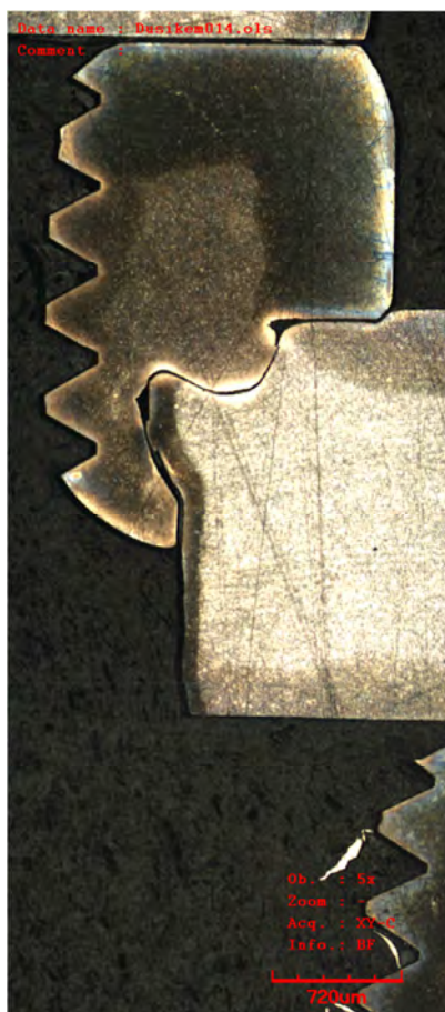
Snímky zalisované matice u metalografického vzorku O 2 – zväčšenie 50x
