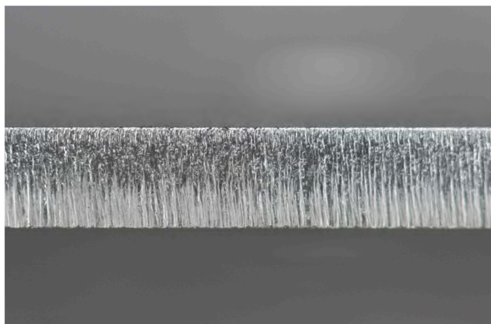
Povrch 02 vzorku u tavného řezání
