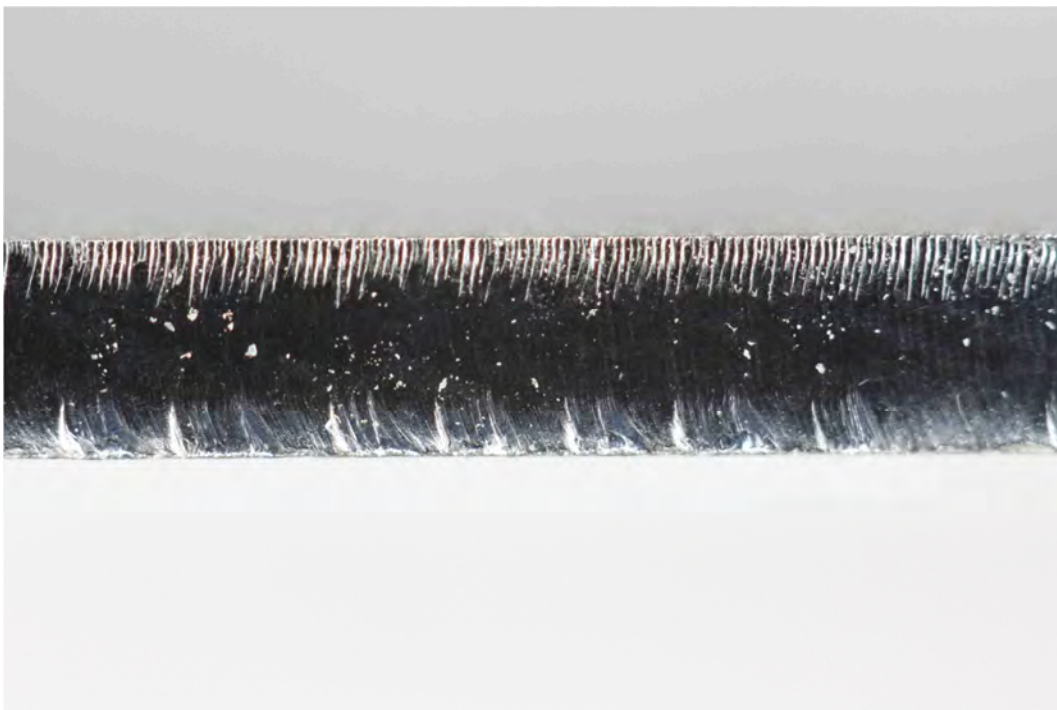
Povrch 03 vzorku u oxidačního řezání
