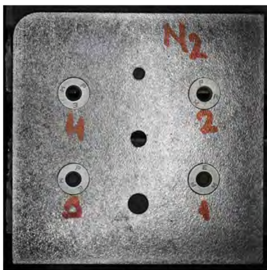
Obr. č. 49 Zalisovaný vzorek N 2
