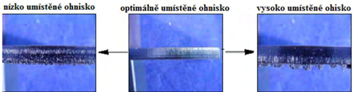
Obr. č. 36 Vliv ohniska – pro tenký materiál [2]
