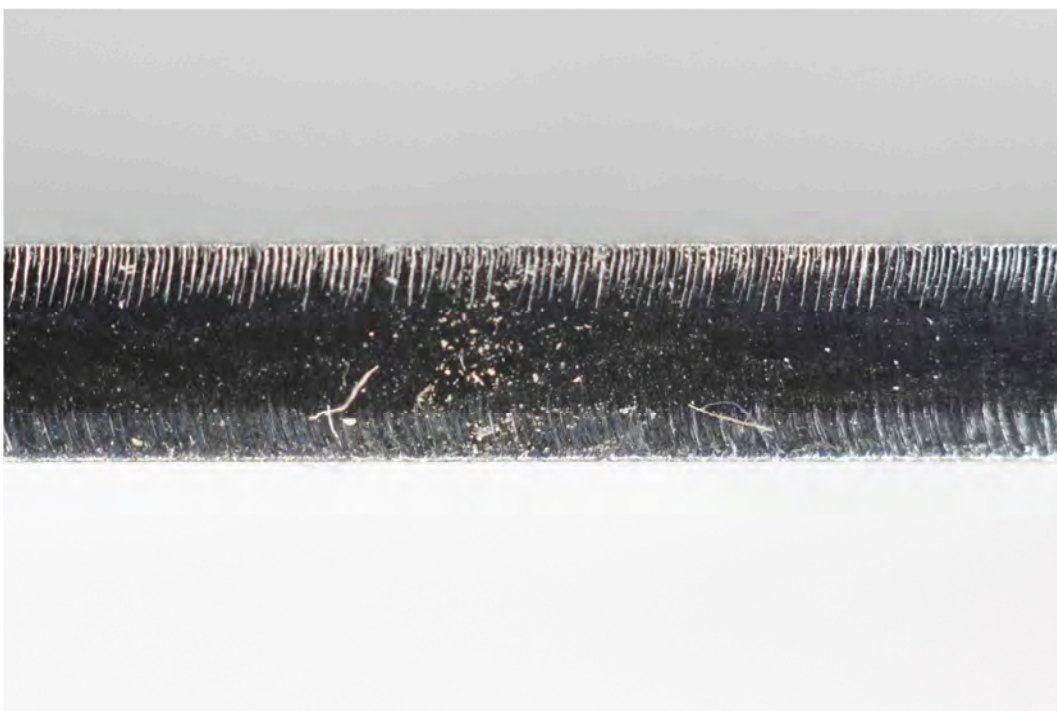
Povrch 02 vzorku u oxidačního řezání
