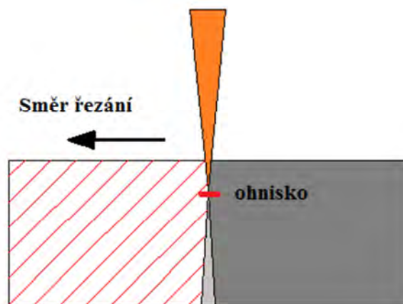
Obr. č. 22 Ohnisko - oxidační řezání [1]
