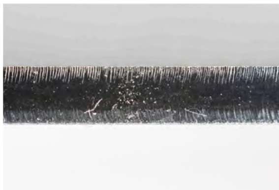
Obr. č. 44 Řezná plocha – oxidační způsob
