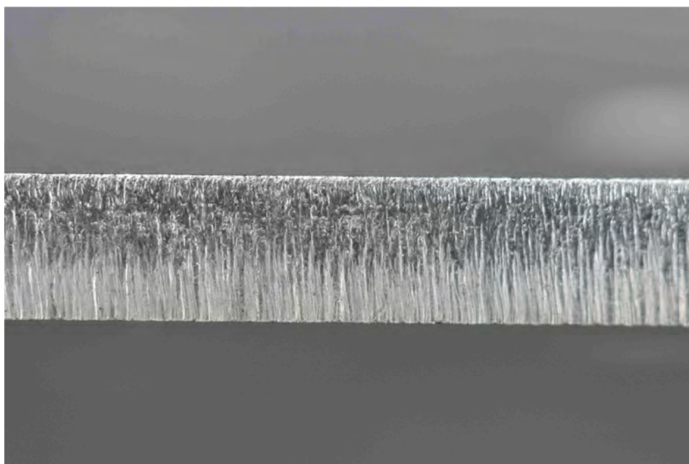
Povrch 01 vzorku u tavného řezání
