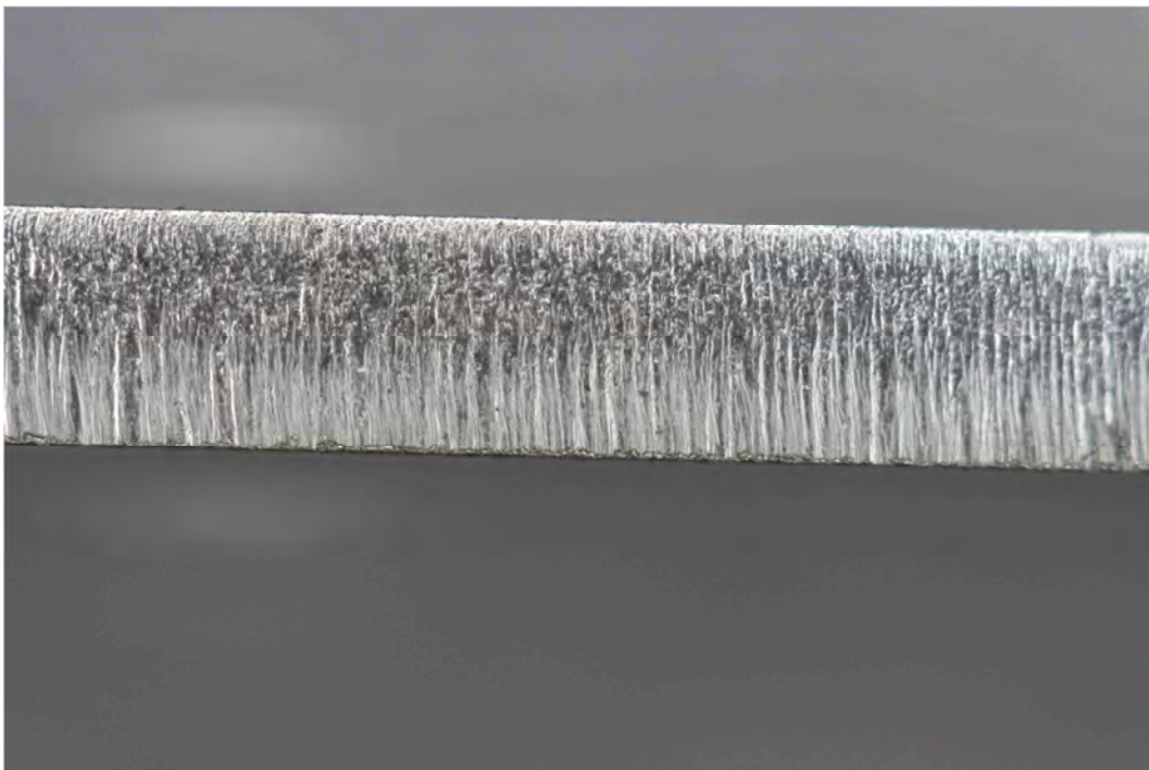
Povrch 04 vzorku u tavného řezání
