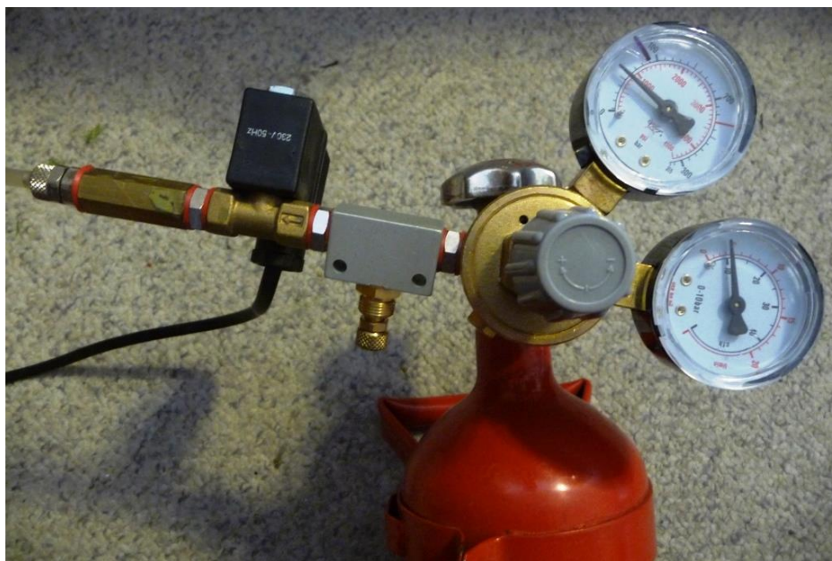
Obr. 5.10: CO 2 systém, z prava: redukční ventil, jehlový ventil, el. magnetický ventil, zpětný ventil.
