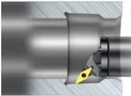
Obr. 25 Ukázka tvarového soustružnického nože při soustružení rohového zápichu [15].
