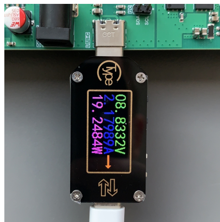
Obr. A.2: Podpora USB-C PD protokolu pre externé spotrebiče.
