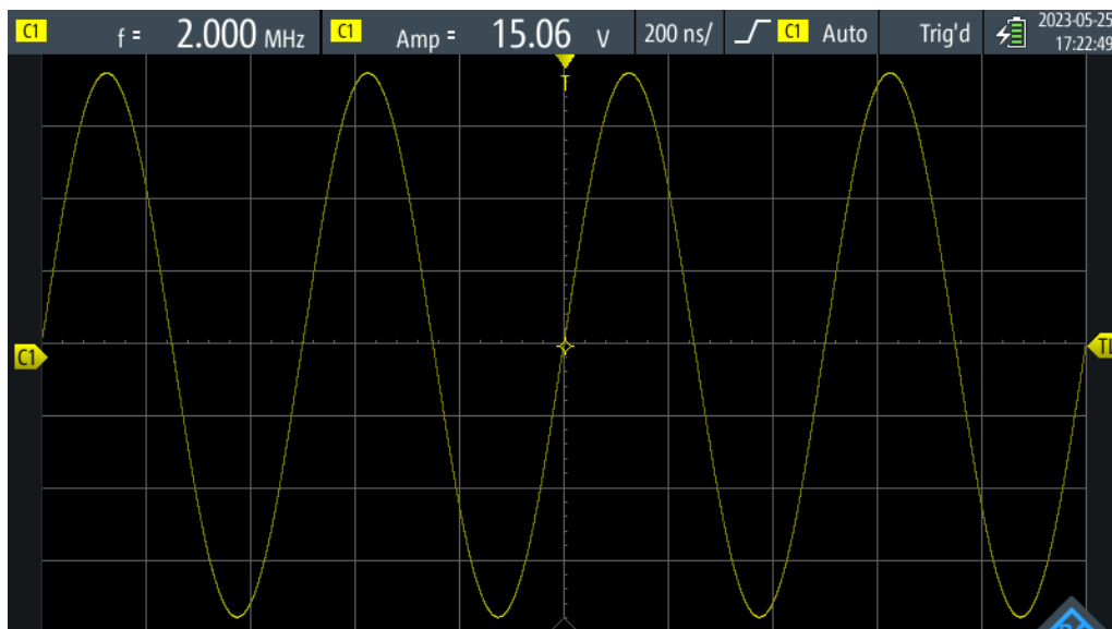
Obr. A.19: Harmonický signál s frekvenciou 2 MHz.
