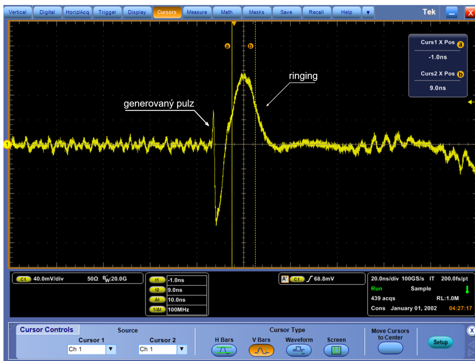
Obr. A.22: Nechcený záchvев výstupného signálu.
