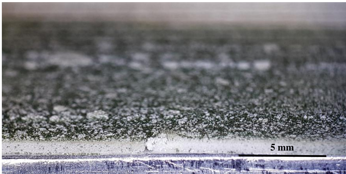
Obr. 20: Častice pripravené roztokovou metódou s prídavkom soli 50 % vzhľadom na hmotnosť polyméru po testovaní abrazívnej schopnosti
