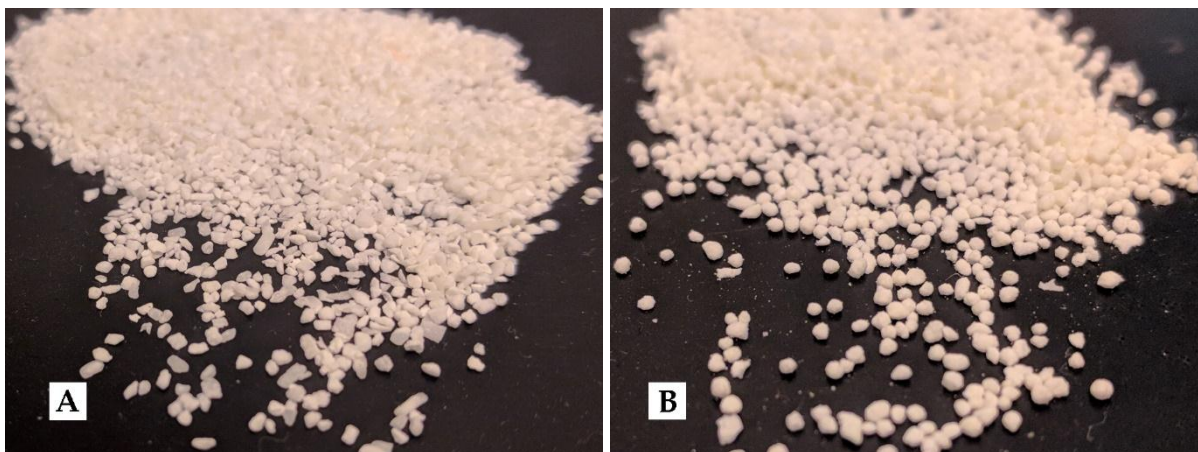
Obr. 11: Ploché častice s ostrejšími hranami (obrázok A) získané použitím banky s objemom 4 l a častice guľovitého tvaru (obrázok B) zbavované rozpúšťadla v banke s objemom 1 l
