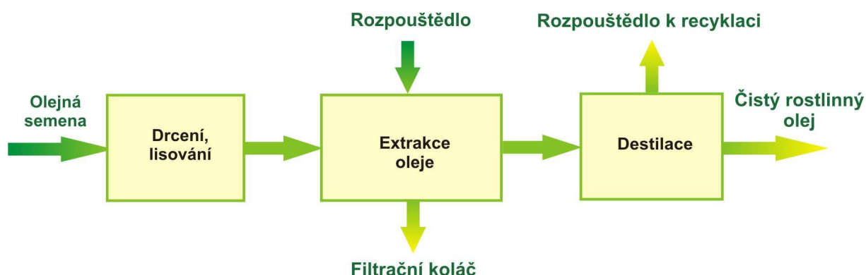
Obr. 3.7: Blokové schéma výroby čistého rostlinného oleje
