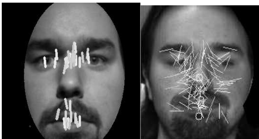
Obrázek 8.4: Ukázka os jednotlivých dvojic(vpravo), osy omezené úhlem tváře vypočítaným pomocí momentů (vlevo)
