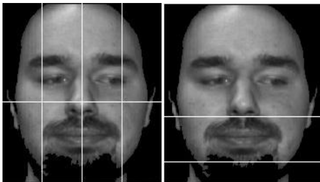
Obrázek 8.2: Ukázka vymezení oblastí pro definici bodů zastupující oči (obrázek vlevo) a zastupující ústa (obrázek vpravo)
