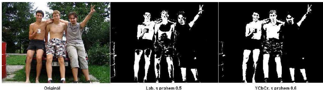
Obrázek 4.6: Porovnání detekce kůže pomocí prostorů Lab s prahem 0,5 a s YCbCr s prahem 0,6
