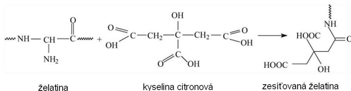
Obrázek 4: Síťovací reakce želatiny kyselinou citronovou [46]
